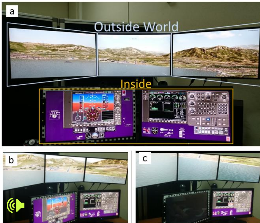
Figure 26 – (a) Photographie du simulateur avec la description des deux zones d'intérêt principales. (b) Photographie du simulateur lors du déclenchement de la notification sonore symbolisée par le haut-parleur. (c) Photographie du simulateur lors de l'apparition de la notification visuelle cachant l'écran du PFD (écran en bas à gauche).
