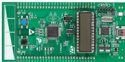
FIGURE 1.13 – Carte d'évaluation STM32L-Discovery de STMicroelectronics contenant le microcontrôleur STM32L152RBT6.
