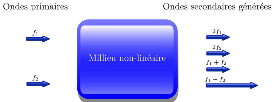
FIGURE 1.8 – Mécanisme d'interaction non-linéaire des ondes générées par l'antenne paramétrique.
