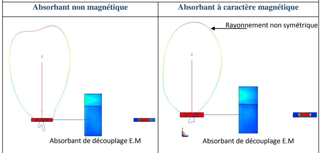
L'absorbant à caractère magnétique en position centrale ne fournit pas un diagramme de rayonnement satisfaisant car nous constatons une absence de symétrie dans la configuration présentée. Réciproquement, pour un absorbant non magnétique, la coupe  $\varphi^\circ = 0^\circ$  présente des oscillations visibles sur le diagramme de rayonnement de 0.5 dBi d'amplitude.
