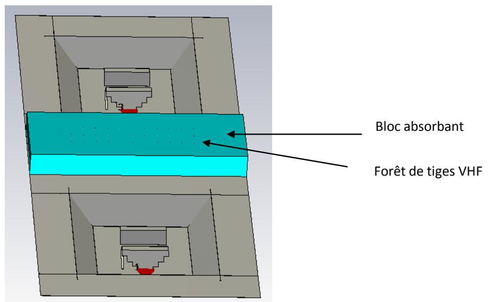
**Figure n°128:** Deux antennes dipôles-boucles en cavité avec un matériau selon la configuration de la figure n° 127.
