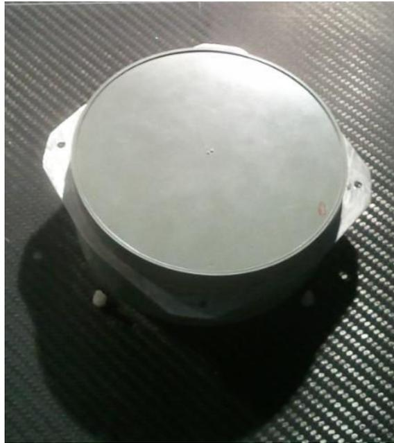
**Figure n°152 :** Représentation de l'antenne IBCA 0540-SP de IMC.
