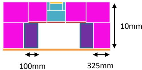
Code de couleur utilisé : orange: parties conductrices, rouge bordeaux: parties conductrices, rose: paroi composite (diélectrique), blanc: mousse à faible permittivité diélectrique (proche de l'air), bleu : substrat diélectrique de l'antenne, violet : ferrites.
