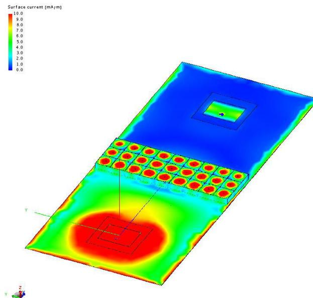
**Figure n°73:** Densité de courant sur les parties conductrices de l'objet calculé lorsque l'antenne située en bas de la figure est en émission. Les deux antennes sont situées au dessus d'une paroi conductrice et découplées par une structure BIE.
