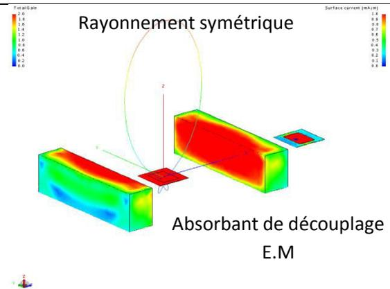
L'absorbant aux propriétés magnétiques donne un résultat satisfaisant avec un gain de 3 dBi. Son diagramme de rayonnement est plutôt directif avec une ouverture à -3 dB de  $64^\circ/95^\circ$ . Pour un absorbant non magnétique, la coupe suivant  $\varphi^\circ = 0^\circ$  comporte toujours des ondulations visibles dont l'amplitude reste toutefois faible (moins de 1 dBi).
