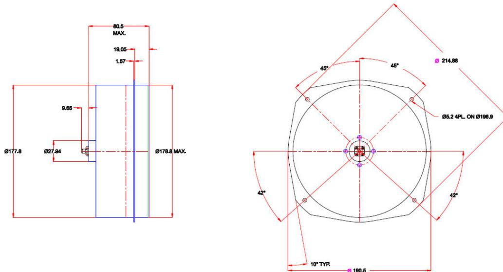
**Figure n°153 :** Dimensions de l'antenne IBCA 0540-SP de IMC.
