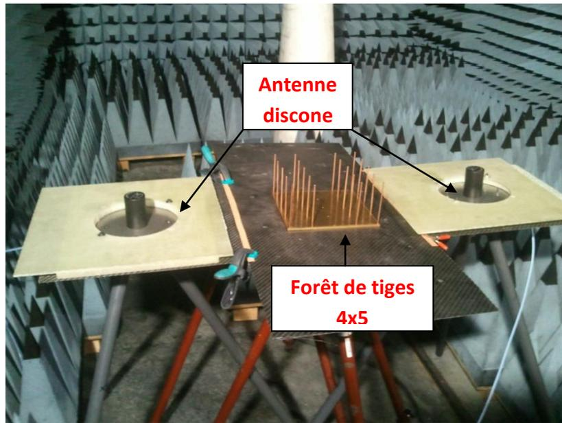
**Figure n°94:** Pour la configuration C (celle de la photo), l'alignement des tiges est situé dans l'axe perpendiculaire à l'axe de visée des deux antennes. Par ailleurs, les autres configurations sont construites sur la même base mais avec 5x5 tiges pour la configuration A et 3x3 tiges pour la configuration D.
