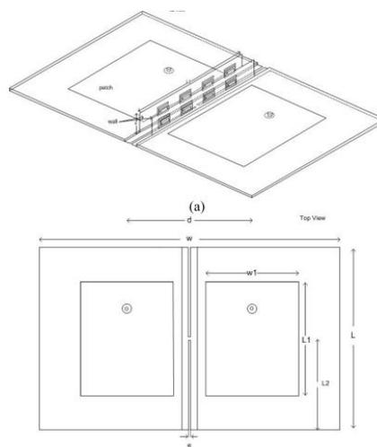
**Figure n°6:** Patches séparés par une structure fente et d'un mur composé d'EBG
