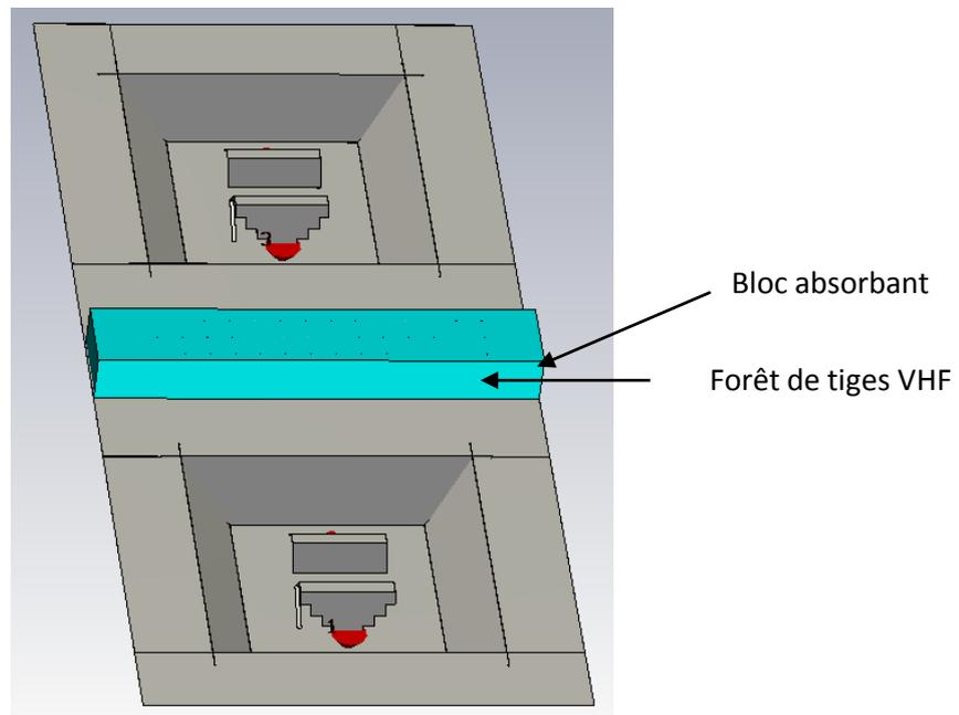
**Figure n°122:** Deux antennes dipôles-boucles en cavité avec un matériau selon la configuration de la figure n°121.
