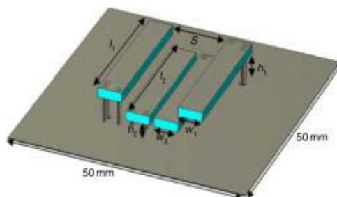
**Figure n°10:** Antennes inversées de type F séparées par deux résonateurs
