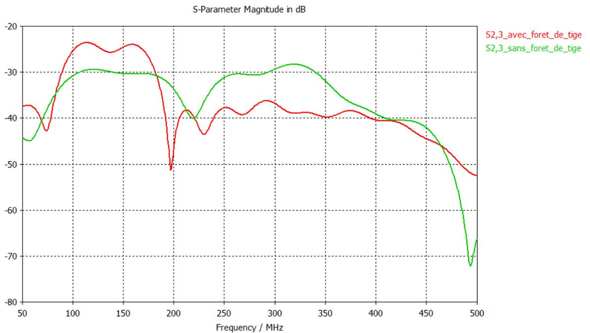
**Figure n°98:** Fonction de transfert entre le port n°2 de l'antenne dipôle-boucle du bas de la figure n°96 et le port n°3 sur l'antenne dipôle-boucle située en haut de la figure n°96.
