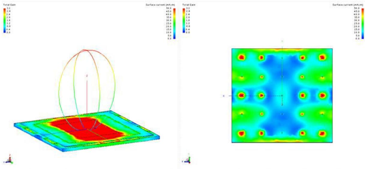
**Figure n°46:** Diagramme de rayonnement d’une antenne patch installée sur une paroi conductrice avec insertion d’une surface haute impédance avec vias. Une cartographie des densités de courant sur la paroi est aussi présentée.
