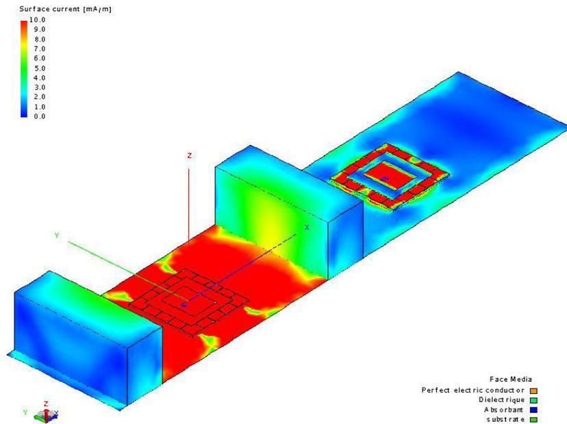
**Figure n°69:** Densité de courant sur les parties conductrices de l'objet calculé lorsque l'antenne située en bas de la figure est en émission. Les deux antennes sont situées au dessus d'une paroi conductrice et elles sont découplées par un absorbant de 15cm.
