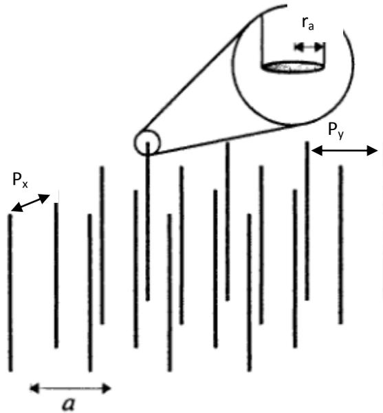
**Figure n°84:** Réseau de tiges métalliques de rayon  $r_a$  et de période  $P_x$  et  $P_y$  (Figure empruntée à l'article original de J. Pendry)
