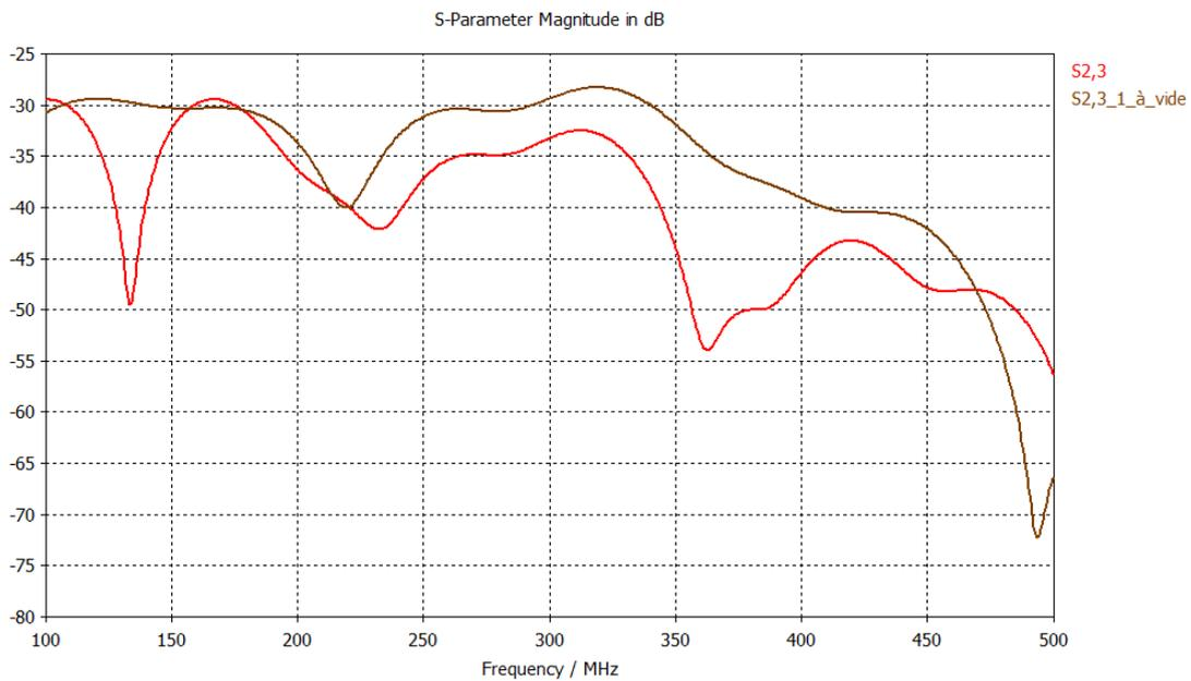
**Figure n°135** : Fonction de transfert entre le port n°2 de l'antenne dipôle-boucle du bas de la figure n°134 et le port n°3 sur l'antenne dipôle-boucle située en haut de la figure n°134.
