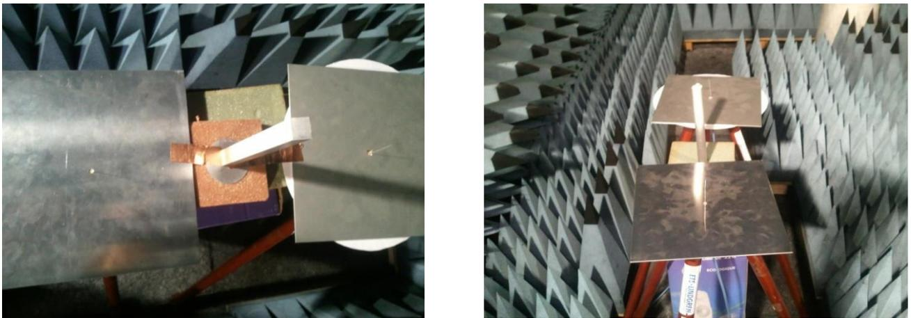
**Figure n°75:** Antennes monopôles avec la tige verticale
