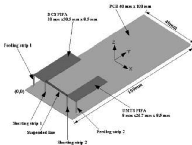
**Figure n°11:** Antennes PIFA reliées par une ligne suspendue
