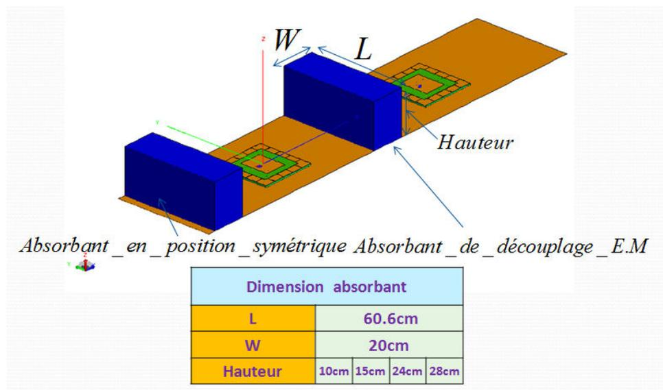
**Figure n°66:** Représentation de deux antennes patch disposées via une surface haute impédance au-dessus d'une paroi conductrice avec leurs absorbants respectifs.
