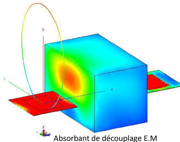
Dans cette coupe  $\varphi^\circ = 90^\circ$ , le diagramme de rayonnement est parfaitement symétrique quelle que soit la nature de la structure absorbante.
