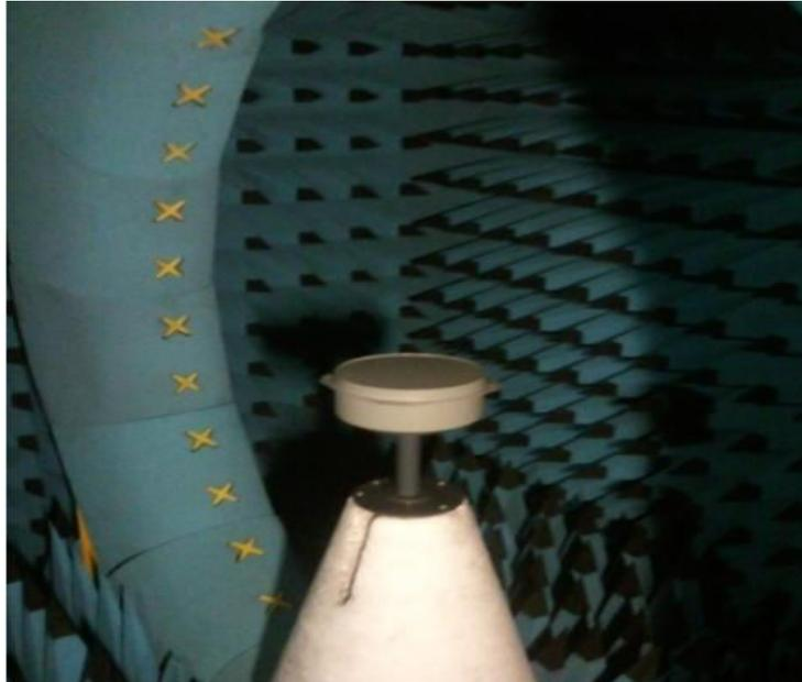
**Figure n°12: Présentation de l'antenne spirale**
