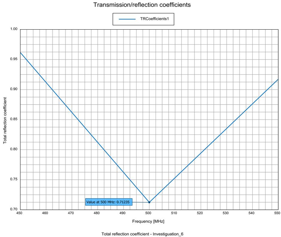
Le coefficient de réflexion est de 0,72 et est localisé à une fréquence centrale de 500 MHz.
