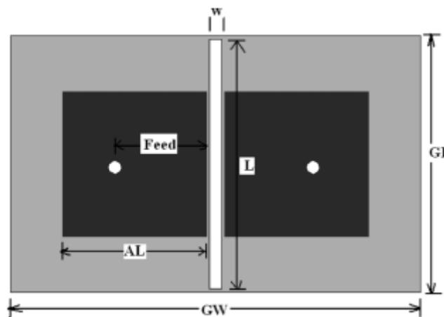
**Figure n°4:** Antennes patchs séparées par une structure fente
