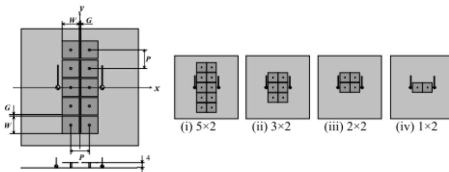
**Figure n°9:** Antennes inversées de type F séparées par une structure EBG
