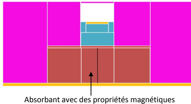
Code de couleur utilisé: orange: parties conductrices, rouge bordeaux: parties conductrices, rose: paroi composite (diélectrique  $\epsilon_r = 5.4$ ), blanc: mousse à faible permittivité diélectrique (proche de l'air), bleu : substrat diélectrique de l'antenne.
