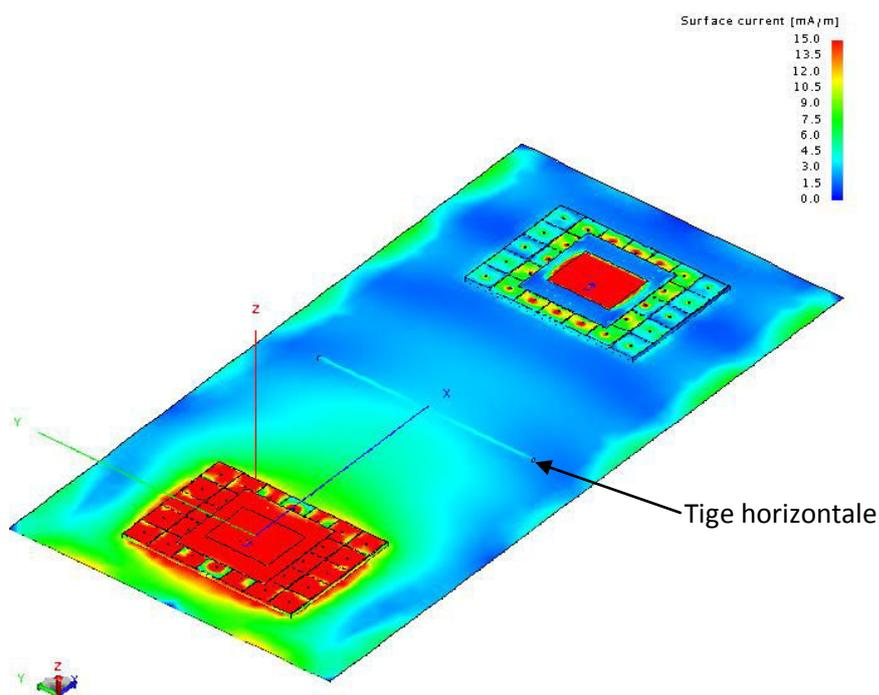
**Figure n°83:** Densité de courant sur les parties conductrices de l'objet calculé lorsque l'antenne située au bas de la figure est en émission. Les deux antennes sont situées au-dessus d'une paroi conductrice et une tige horizontale est centrée au milieu des deux antennes.
