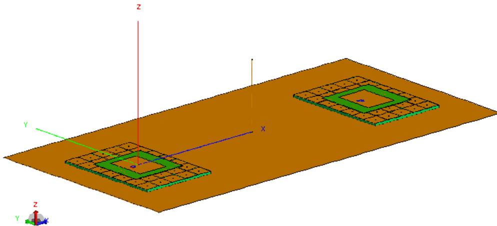
**Figure n°81:** Représentation de deux antennes patch disposées via une surface haute impédance au dessus d'une paroi conductrice. Une tige conductrice est interposée entre les deux antennes pour assurer un découplage.
