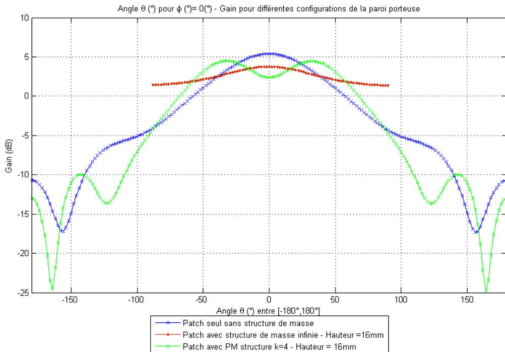
**Figure n°24:** Gain pour différentes configurations de la paroi porteuse
