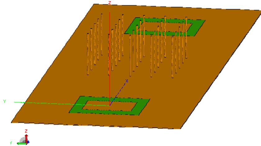
**Figure n°85:** Forêt de tiges insérée entre deux antennes patches au-dessus d'une paroi conductrice pour une distance d'une longueur d'onde.
