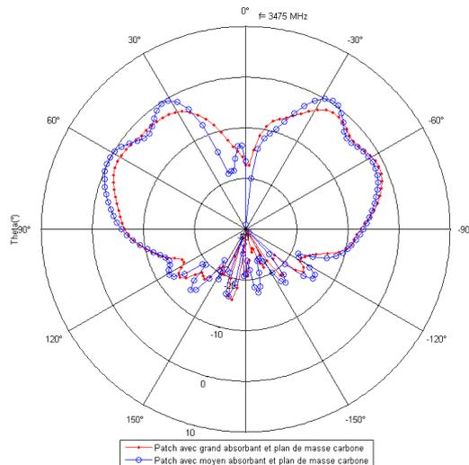
**Figure n°37:** Diagramme de rayonnement de l'antenne Patch dans le plan  $\varphi=90^\circ$  au dessus d'un plan carbone de dimension 450 x 450 mm .Un absorbant de type C-RAM-30 de dimension 300 x 200 mm (épaisseur 10 mm) est inséré (courbe bleue). Un absorbant de même type mais de dimension pratiquement égale à celle du plan carbone 450 x 450 mm est inséré (courbe rouge)
