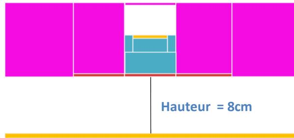
**Figure n°25:** Hauteur minimale préservant les performances de l'antenne
