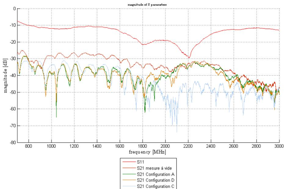
**Figure n°95:** Fonction de transfert ( $S_{2,1}$  en dB) entre deux antennes ARA CMP 727 NMO-2 sans dispositif de découplage (courbe rouge bordeaux) puis avec dispositif de découplage de type forêt de tiges pour trois configurations différentes.
