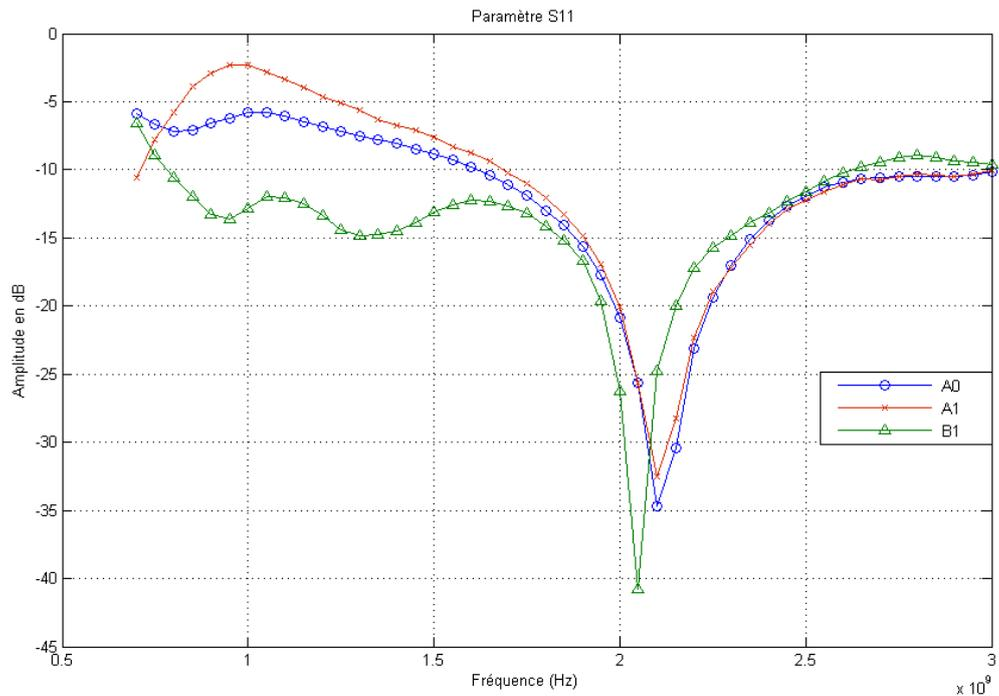
Conclusion sur le gain et le  $S_{1,1}$ : l'influence des différentes solutions d'intégration sur le gain est très faible et ne permet pas de tirer des conclusions. Un léger décalage en fréquences apparait pour l'antenne CMP en position semi-intégrée probablement du à l'influence du plan de masse.
