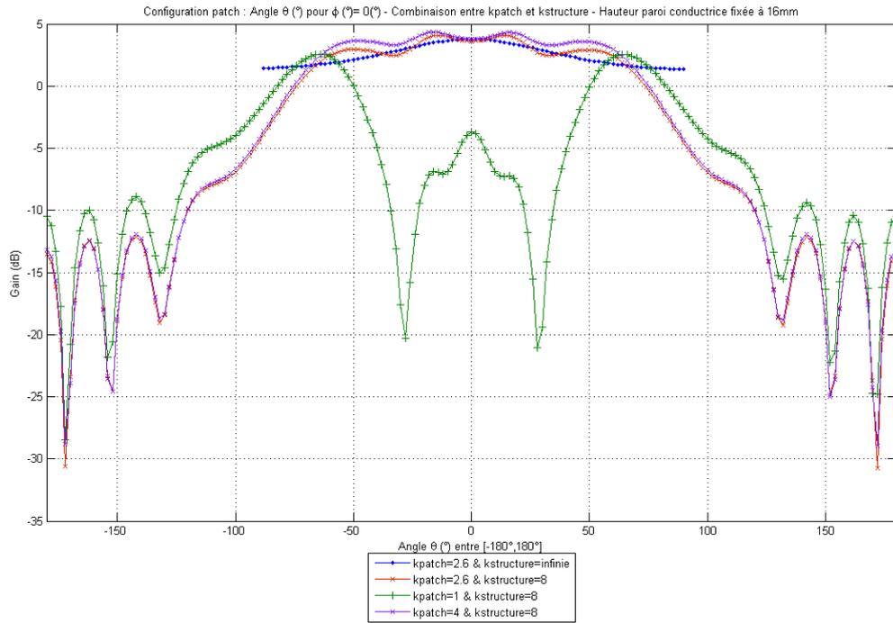
**Figure n°20:** Gain pour différentes configurations de  $k_{patch}$  et  $k_{structure}$  pour  $\Phi=0^\circ$
