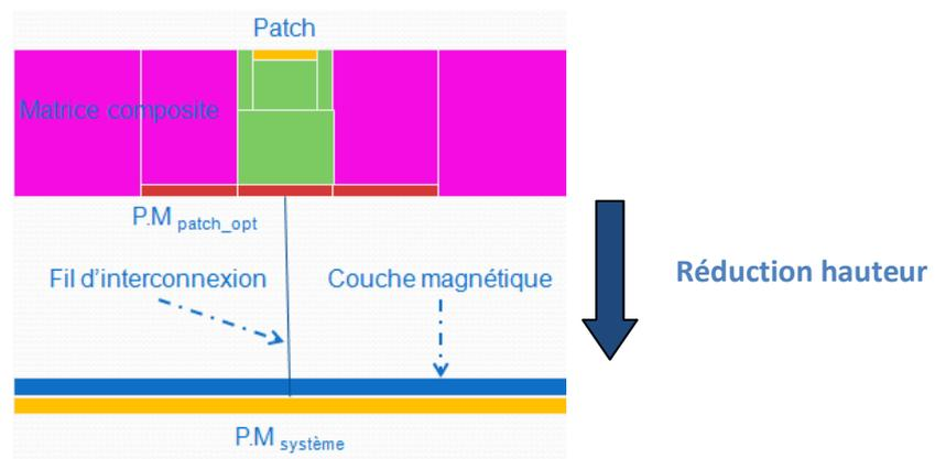
La couche magnétique est disposée au dessus du plan de masse système. Un fil d'interconnexion relie les deux structures de masse.
