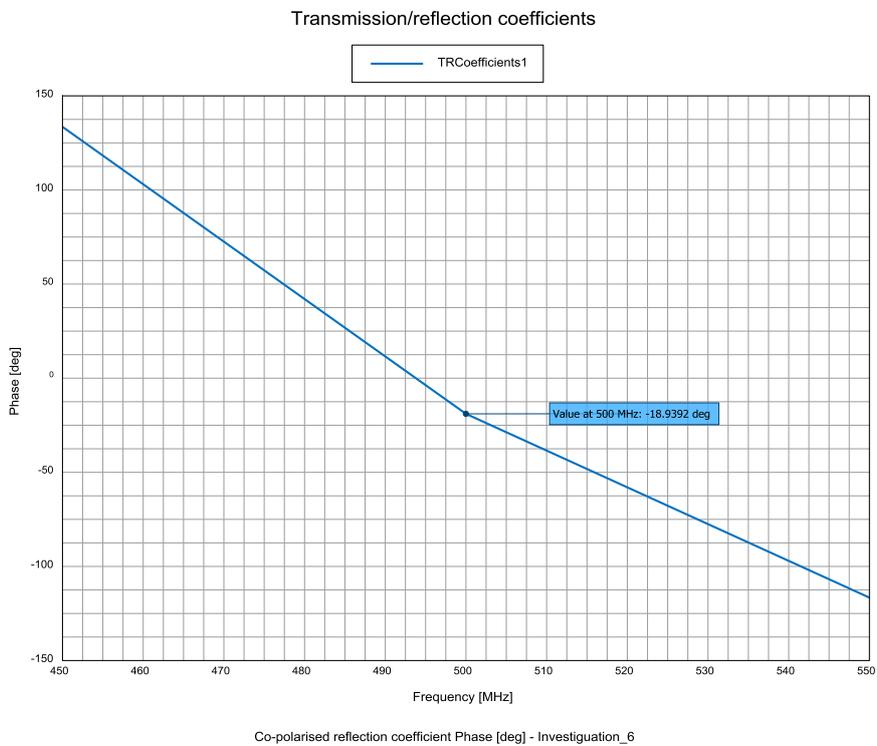
La phase du coefficient de réflexion est de  $-18,8^\circ$  à la fréquence d'accord du patch de 500 MHz, ce qui est tout à fait acceptable.
