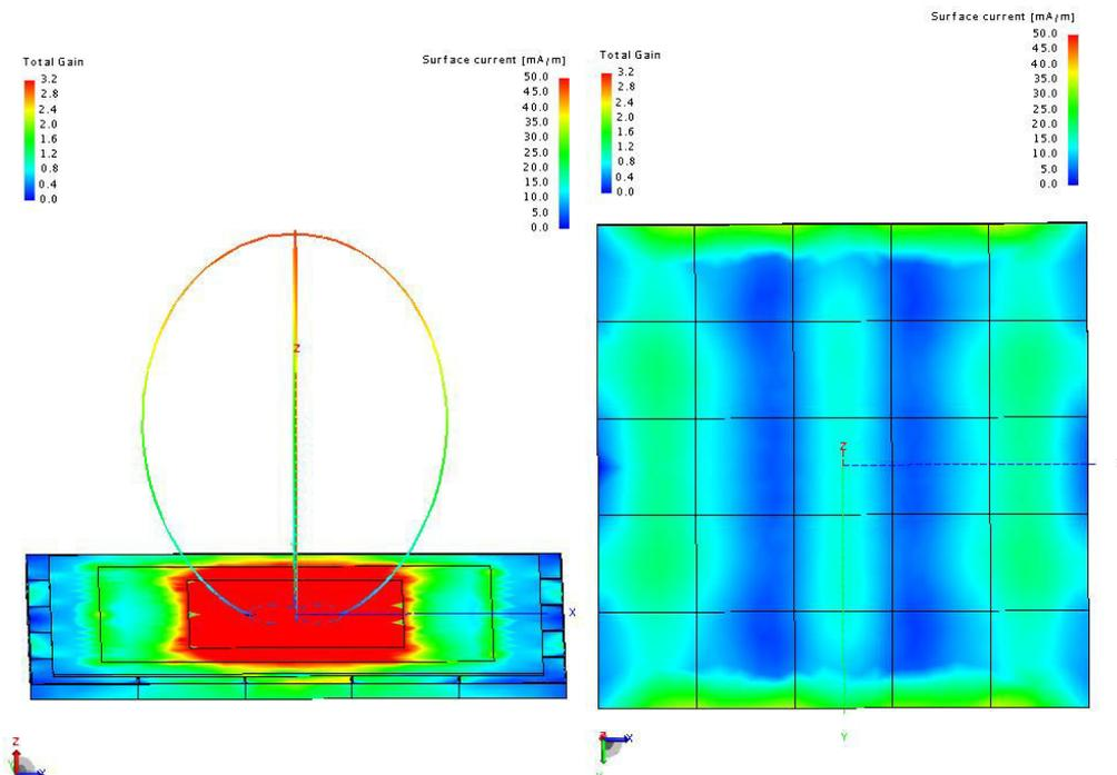
**Figure n°47:** Diagramme de rayonnement d’une antenne patch installée sur une paroi conductrice avec insertion d’une surface haute impédance sans vias. Une cartographie des densités de courant sur la paroi est aussi représentée.
