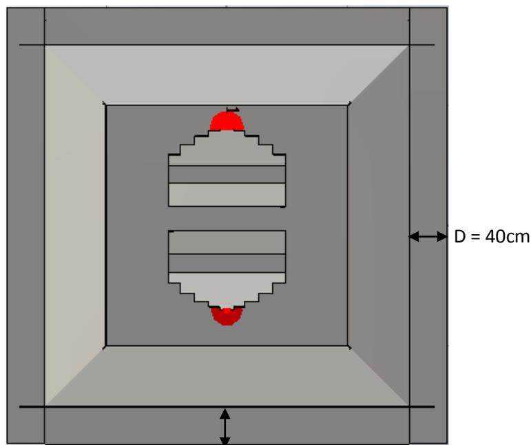
**Figure n°102:** Antenne dipôle-boucle en cavité séparée du bord par une distance  $D$
