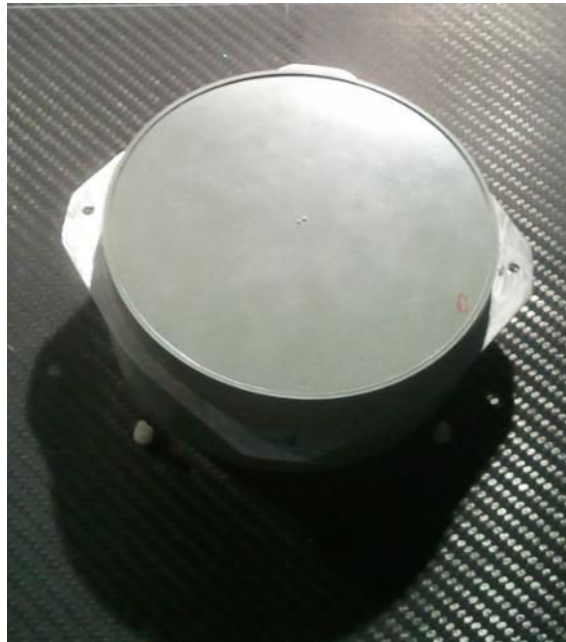
Figure n°152 : Représentation de l'antenne IBCA 0540-SP de IMC.
