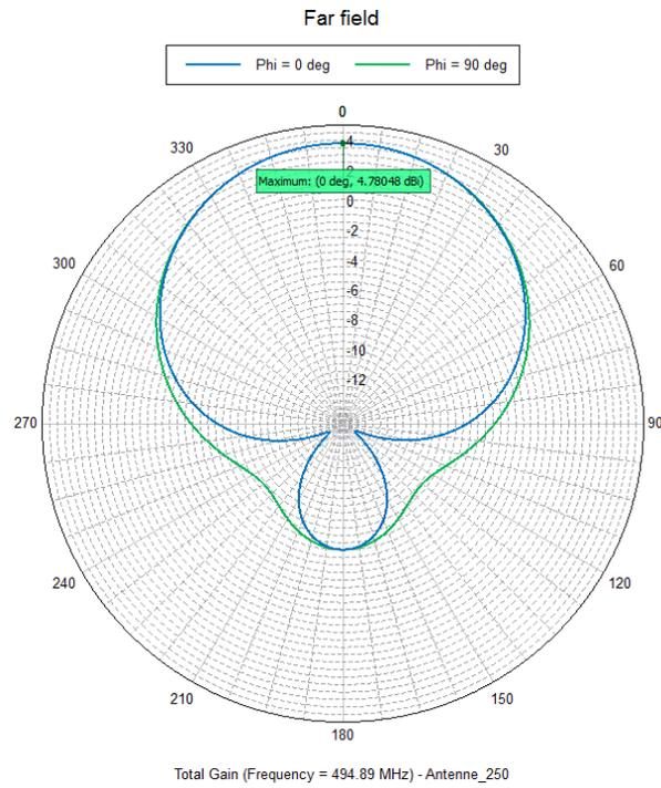
**Figure n°19:** Diagramme de rayonnement pour  $k_{\text{patch}}=2.6$
