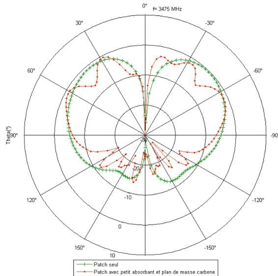
**Figure n°36 :** Diagramme de rayonnement de l'antenne Patch dans le plan  $\varphi=90^\circ$  lorsque l'antenne est mesurée en espace libre (courbe verte) et lorsque qu'elle est située au-dessus d'un plan carbone 450 x 450 mm avec insertion d'un absorbant de type C-RAM-30 de dimension 150 x 150 mm (épaisseur 10 mm) est inséré (courbe rouge).
