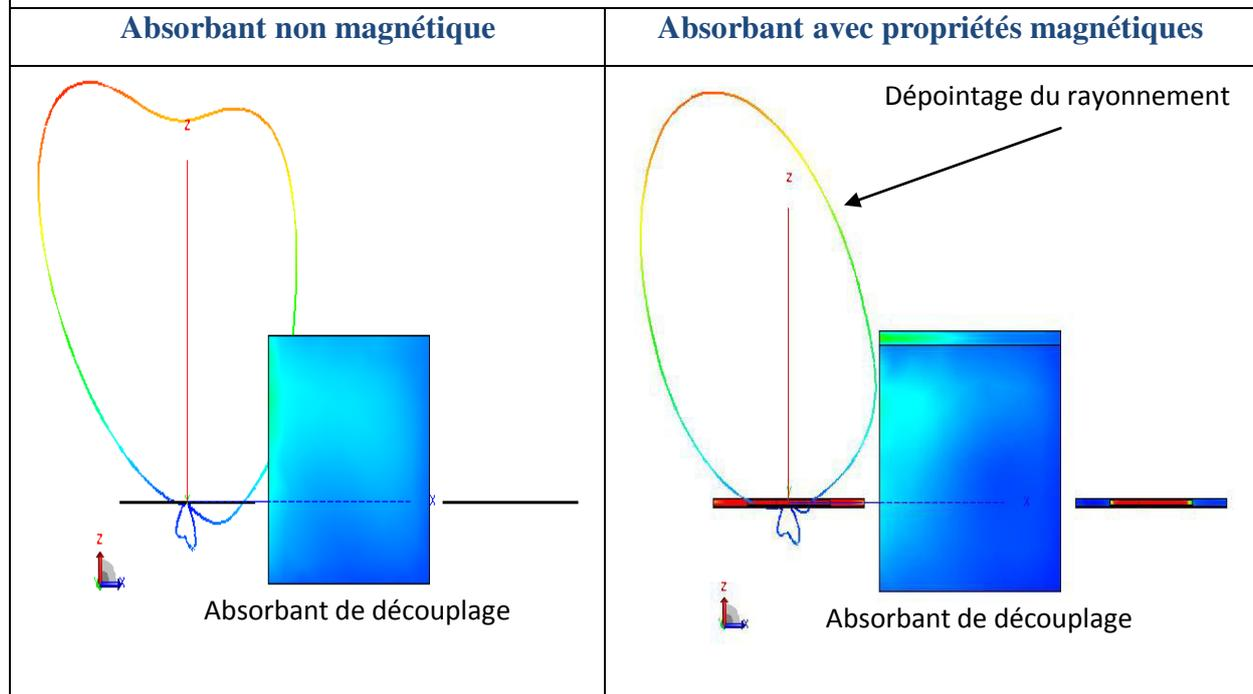
L'absorbant avec des propriétés magnétiques ne fournit pas un diagramme de rayonnement acceptable car nous constatons un léger dépointage à  $345^\circ$ . Dans l'autre cas, nous observons des oscillations d'amplitude 0,2 dB.
