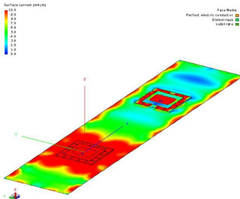
**Figure n°70:** Densité de courant sur les parties conductrices de l'objet calculé lorsque l'antenne située en bas de la figure est en émission. Les deux antennes sont situées au dessus d'une paroi conductrice.
