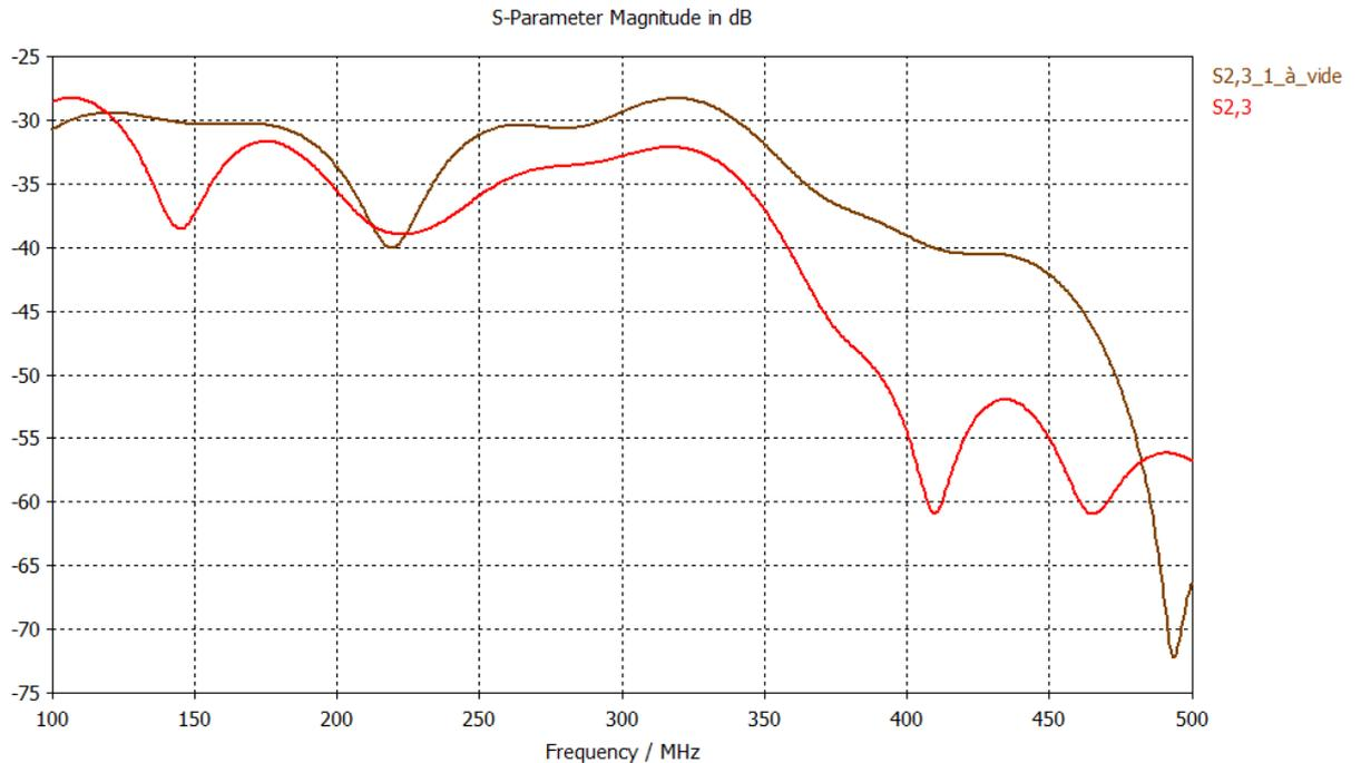
**Figure n°130** : Fonction de transfert entre le port n°2 de l'antenne dipôle-boucle du bas de la figure n°128 et le port n°3 sur l'antenne dipôle-boucle située en haut de la figure n°128.
