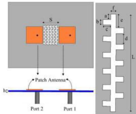
**Figure n°8:** Patches séparés par une structure DGS sur le plan de masse
