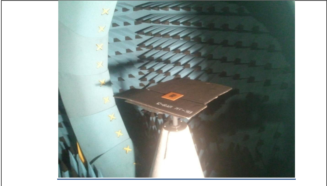
Figure n°35: Photos d'installation de l'antenne patch au-dessus d'un plan de masse en base champ proche avec insertion d'absorbants de dimensions variables.
