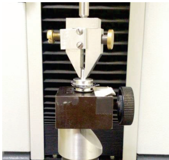
Figure 50 - Dispositif d'essai d'arrachement avec le système des mors.
