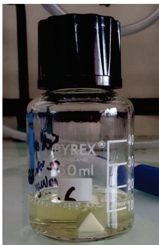
Figure 65 - Sol d'alcoxyde de cérium avec les ratios: (Ce(OBu)_4)/2-BuOH = 0,01 , (Ce(OBu)_4)/H_2O = 0,4 , (Ce(OBu)_4)/AcAc = 2(GB\_SG\_001) .
