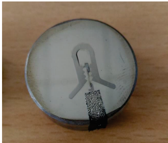
Figure 40 - Corps-cône neuf recouvert de parylène C et de fluoro-polymère, enrobé, découpé, poli et métallisé afin de l'observer au MEB.
