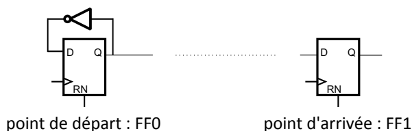
FIGURE 3.24 : Principe de fonctionnement d'un circuit répliqué
