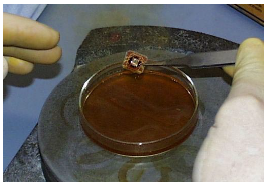
FIGURE 1.1 : Désassemblage du boîtier avec de l'acide nitrique [Kömmerling 1999]
