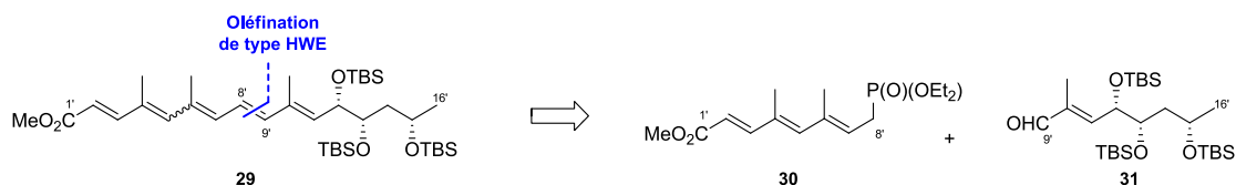
Schéma 6 : Analyse rétrosynthétique du fragment C1'-C16' par Kishi (2001-2002)
