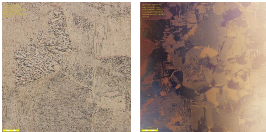
Figure B.2. Microstructure du Ti-6Al-4V \alpha\beta équiaxe dans le plan L-LT. Echelle 100 \mu\text{m} (gauche), 500 \mu\text{m} (droite, lumière polarisée).
