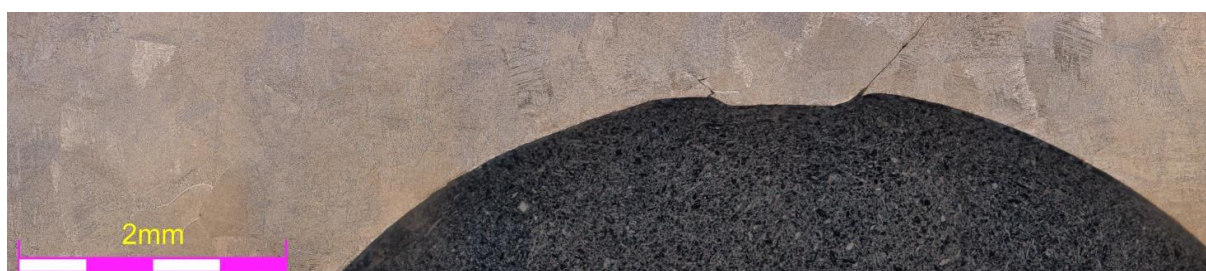
Figure 4.3.12. Fente de la bague après expansion (8%) d'un alésage en Ti-6Al-4V \beta (bague à 0^\circ ).
