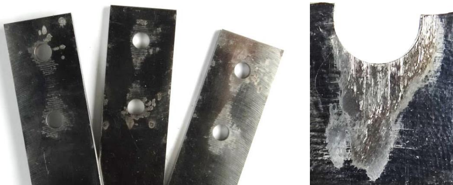
Figure 5.4.6. Usure aux interfaces des éprouvettes de référence en Ti-6Al-4V \alpha\beta : sollicitations inférieures (gauche) et supérieures (droite) au seuil de rupture en fatigue.
