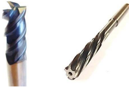
Figure 4.2.4. Outils de réalésage orbital (gauche) et axial (droite).
