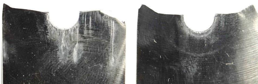
Figure 5.4.7. Zone d'usure au bord de trou sur éprouvette référence (gauche) et expansée (droite).
