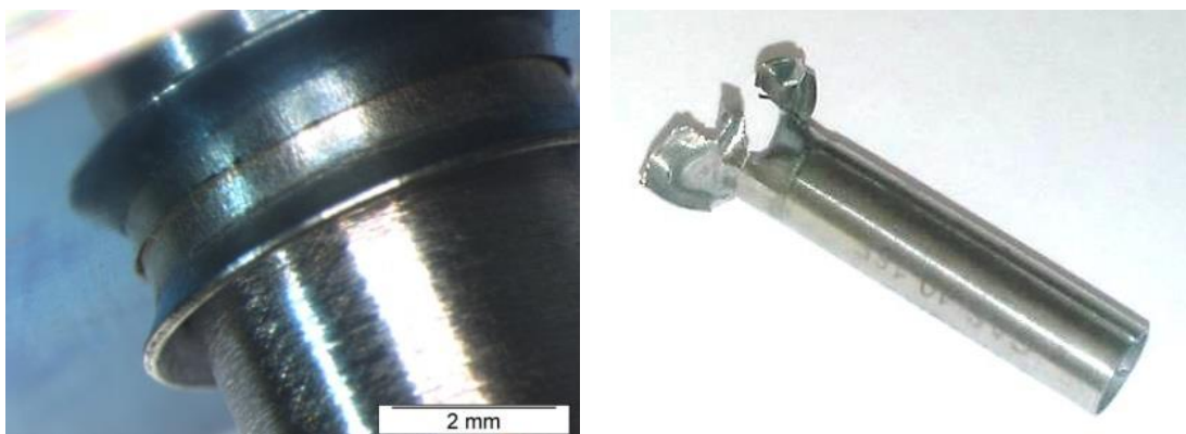
Figure 4.3.1. Mise en position incorrecte de la bague d'expansion et rupture associée.
