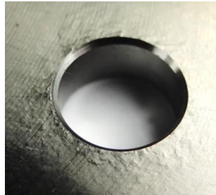
Figure 4.3.21. Observation de l'effet « volcan » par texturation du grain sur un alliage Ti-6Al-4V \beta après expansion de 6%, réalésage et chanfreinage du trou.
