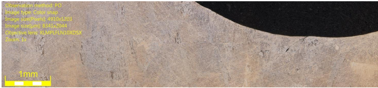
Figure 4.3.13. Fente de la bague après expansion (8%) d'un alésage en Ti-6Al-4V \beta (bague à 90°).
