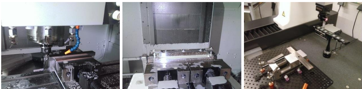
Figure 4.2.3. Usinage des éprouvettes: surfacage, pré-perçage et contrôle dimensionnel.
