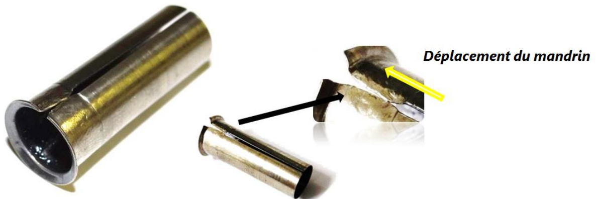
Figure 4.3.5. Bague fendue après expansion à froid.
