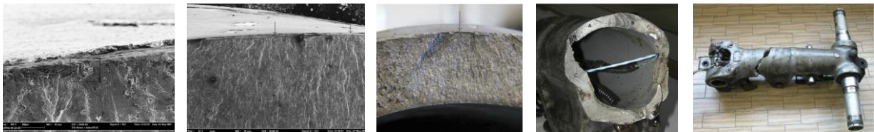
Figure 2.2.3. Le processus de rupture généralisée d'un bras oscillant de train d'atterrissage, d'après [BAG1].
