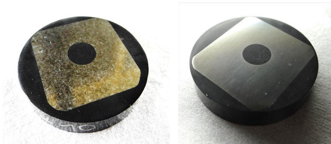
Figure 4.3.10. Préparation des échantillons pour analyse micrographique.
