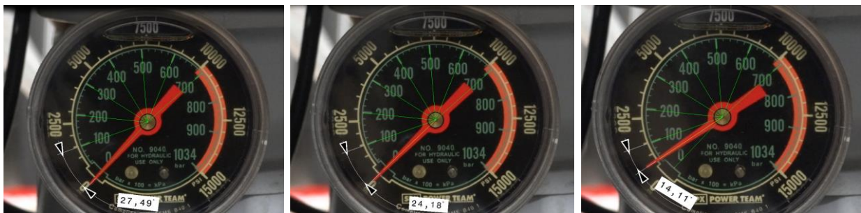
Figure 4.3.24. Mesure des pressions P0, P1 et P2 lors de l'expansion d'un alésage en Ti-6Al-4V \alpha\beta (6%).
