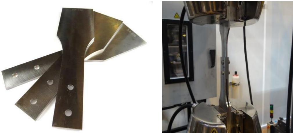
Figure 5.4.1. Éprouvette d'essai pour assemblage à double recouvrement.
