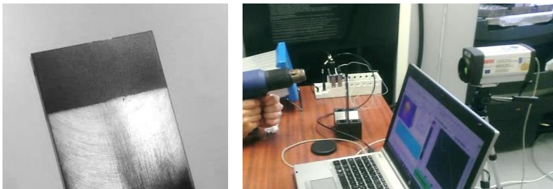
Figure 4.5.1. Peinture mate du Ti-6Al-4V (gauche) et calibrations des méthodes de mesure (droite).
