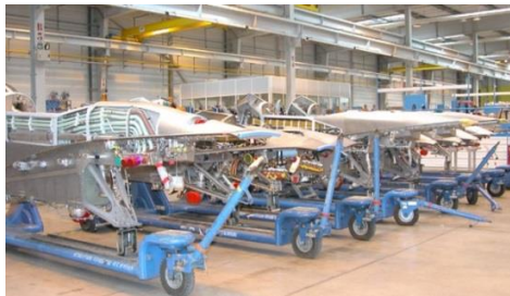
Figure 1.3.1. L'assemblage des mâts réacteurs, d'après [AIR3].
