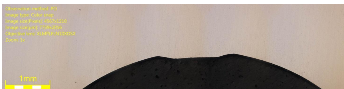
Figure 4.3.11. Fente de la bague après expansion (8%) d'un alésage en Ti-6Al-4V \alpha\beta (bague à 0^\circ ).
