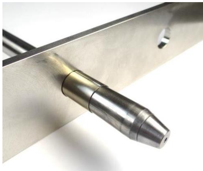
Figure 4.2.6. Procédé industriel d'expansion à froid « à bague fendue ».
