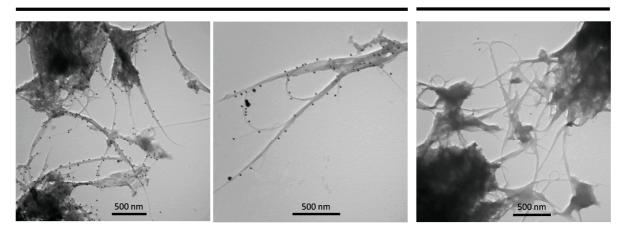
Figure IV.III Images MET du conjugué covalent (19-Ab) et du conjugué obtenu par la réaction contrôle (19/Ab) après marquage avec un anticorps secondaire anti-humain relié à des billes d'or (anti-human IgG).
