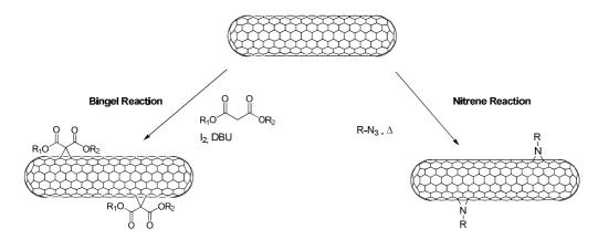
Schéma IV.1 Fonctionnalisation des nanotubes de carbone par réaction de Bingel et cycloaddition de nitrènes.
