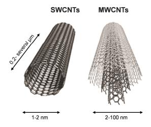
Figure I.I Représentation de nanotubes de carbone à simple paroi et à parois multiples.
