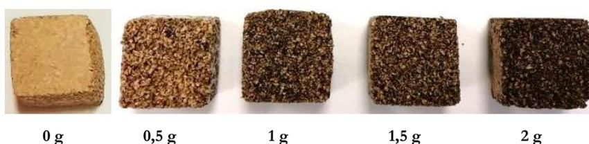
Figure 5.14 : Photos des échantillons réalisés à base de poudre d’algues carbonisée de concentration croissante
