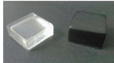
Table 3.2. Proportions utilisées pour réaliser les résines époxy chargées en noir de carbone ; photo d'un composite non chargé (gauche) et chargé (droite)
