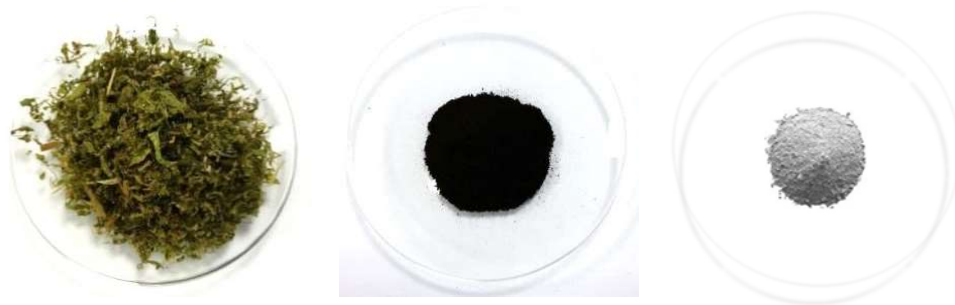
Figure 5.8. Algues vertes broyées, séchées et transformées en une poudre noire par traitement thermique
