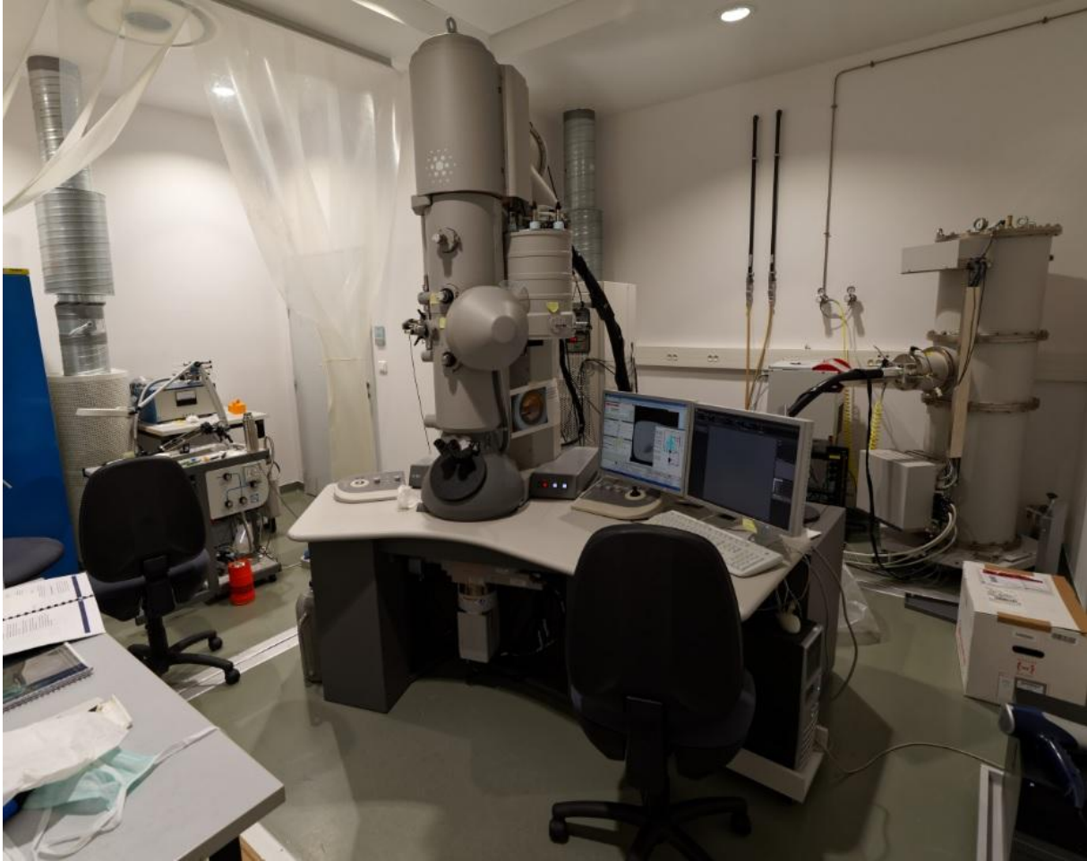
Figure 43: Photographie du Polara (FEI) de l'institut IGBMC/CBI. Il s'agit d'un microscope pour la cryo-microscopie électronique.
