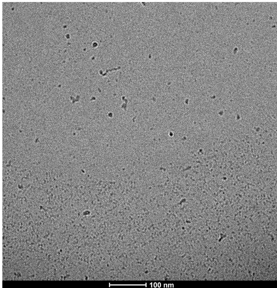
Figure 68 : Micrographe illustrant les problèmes de distributions des particules. On peut voir ici que la majorité des particules sont présente sur le bord inférieur du micrographe.
