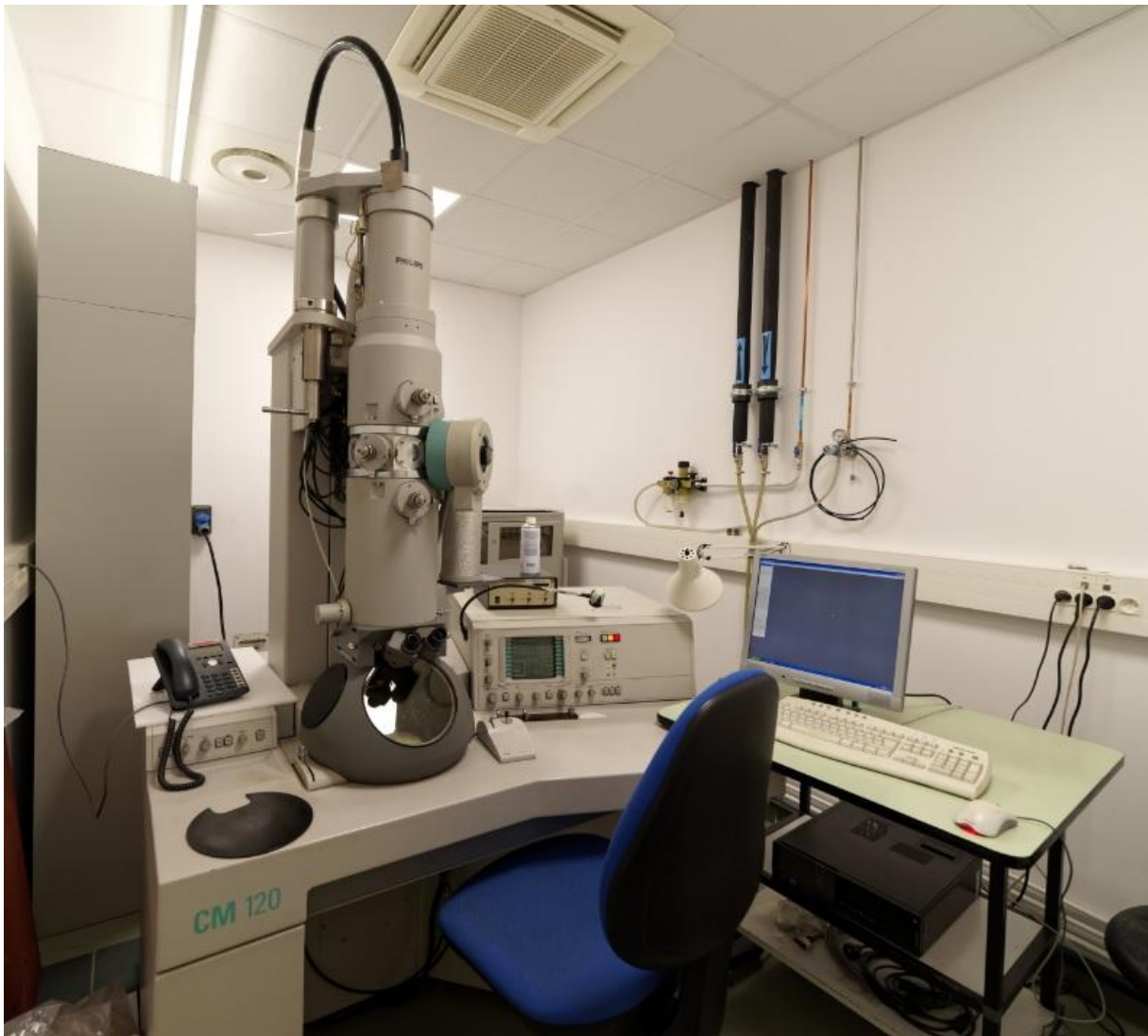
Figure 39 : Photographie du CM120 (Philips) de l'institut IGBMC/CBI. Il s'agit du microscope pour la coloration négative.
