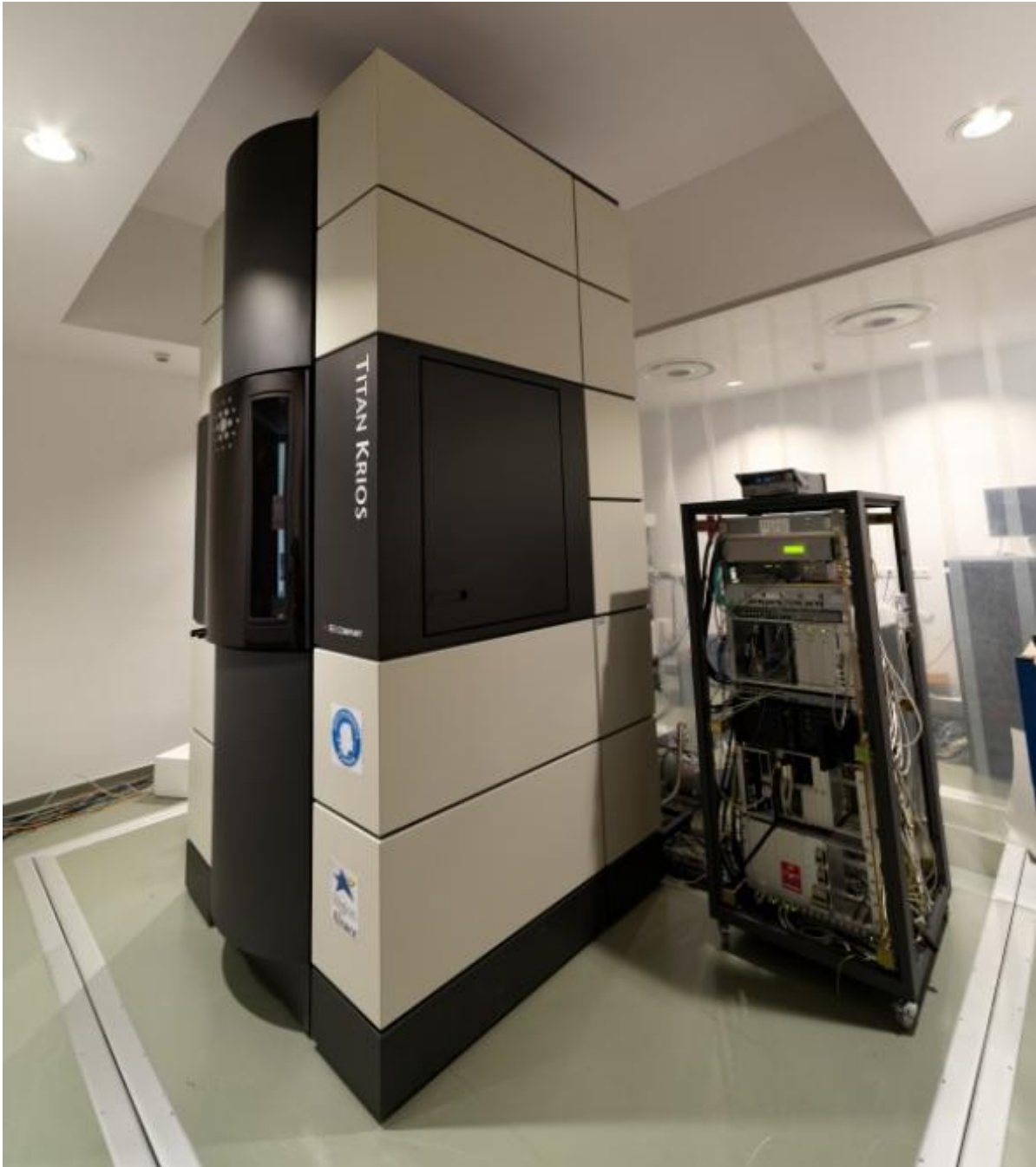
Figure 42 : Photographie du Titan Krios (FEI) de l'institut IGBMC/CBI. Il s'agit d'un microscope pour la cryo-microscopie électronique.
