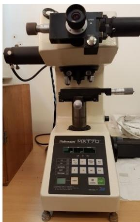
Figure II-14 : Photographie du microduromètre MXT-70 Matsuzawa®
