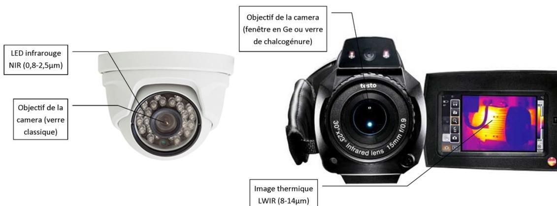
Figure I-8 : Caméras infrarouges à "vision nocturne" vis-NIR (à gauche) et à vision thermique LWIR TESTO© (à droite)
