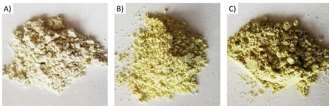
Figure III-18 : Aspect des poudres CLS de ratios La/Ca = 2,3 (A) ; 5,0 (B) et 10,0 (C)
