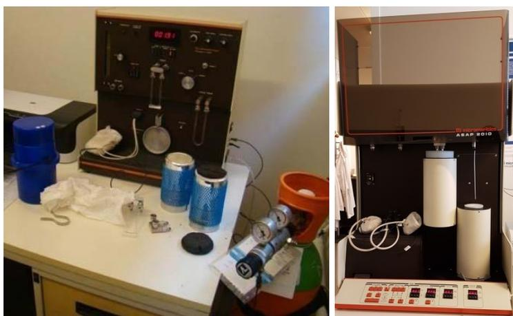
Figure II-7 : Analyseurs Micromeritics monopoint FlowsorbII 2300 (à gauche) et multipoints ASAP 2010 (à droite)
