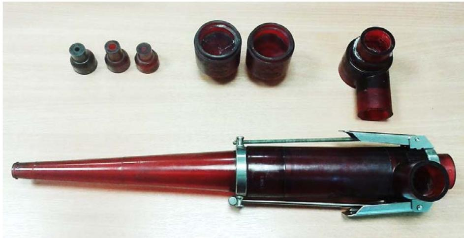
Figure 35 : Composants permettant l'assemblage de l'hydrocyclone
