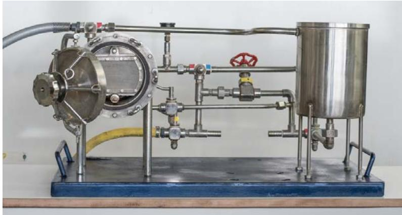
Figure 29 Pilote de filtration sur précouche
