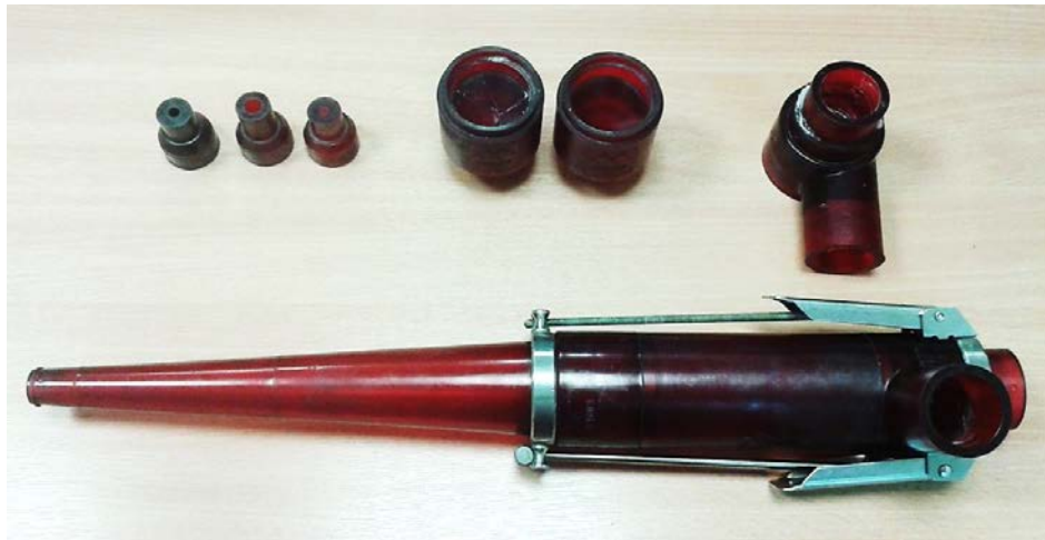
Figure 35 : Composants permettant l'assemblage de l'hydrocyclone
