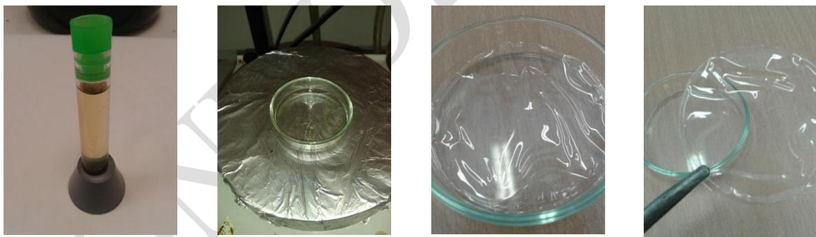
Figure 68 Différentes étapes de formation d'un film de polymère
