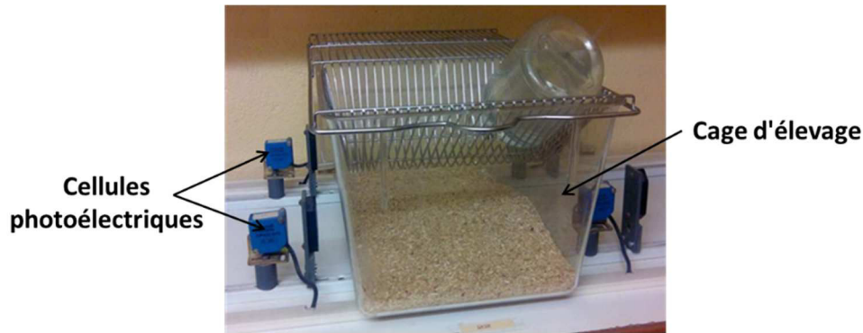
Figure 26 : Test d'actographie en cage d'élevage.
