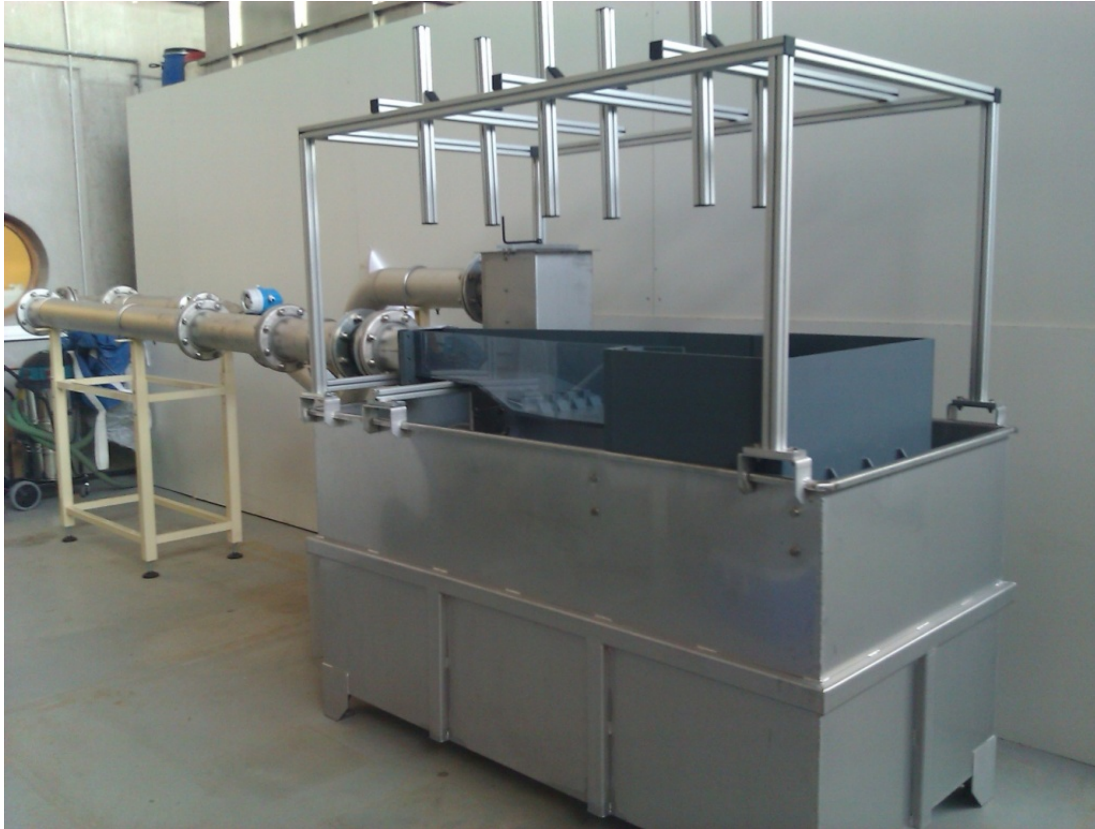
Figure 82. Pilote DSM, échelle 1:5 d'un ouvrage réel recevant un diamètre \phi 1000 en entrée.
