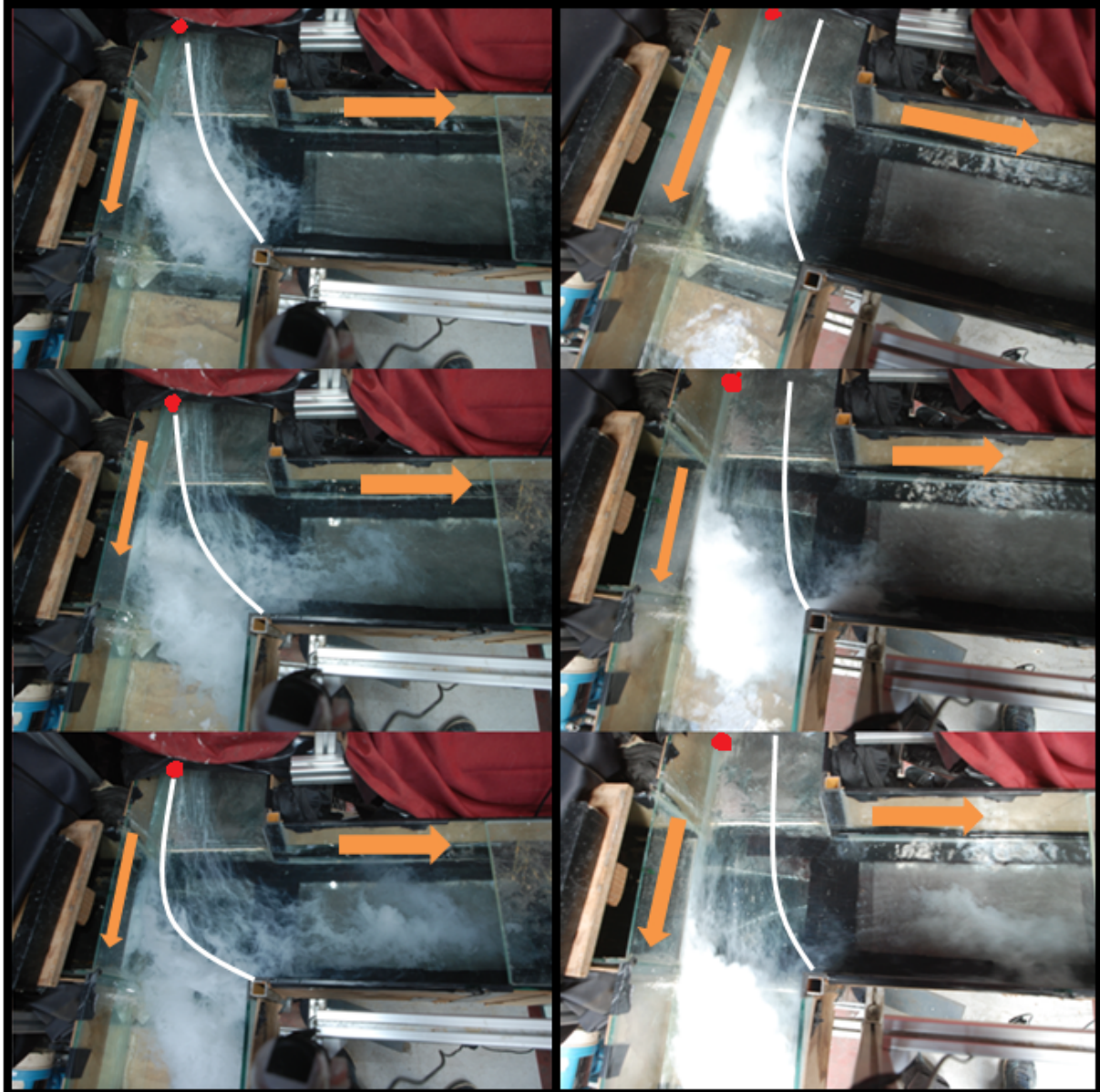
Figure 93. Expérience de l'injection de gouache dans le canal amont pour l'écoulement F1 à gauche et F2 à droite (voir Tableau 22). Les flèches orange indiquent le sens de l'écoulement, les points rouges dans le canal amont l'endroit où la gouache a été injectée près du fond. Les lignes blanches indiquent une séparation qualitative de l'écoulement près du fond.
