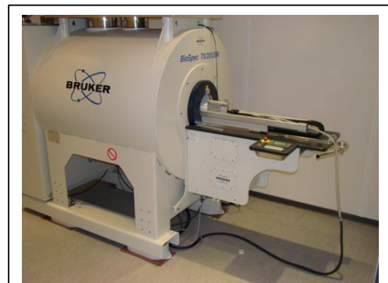
Figure 46 : Appareil IRM 7 Tesla BioSpec de chez Bruker BioSpin.
