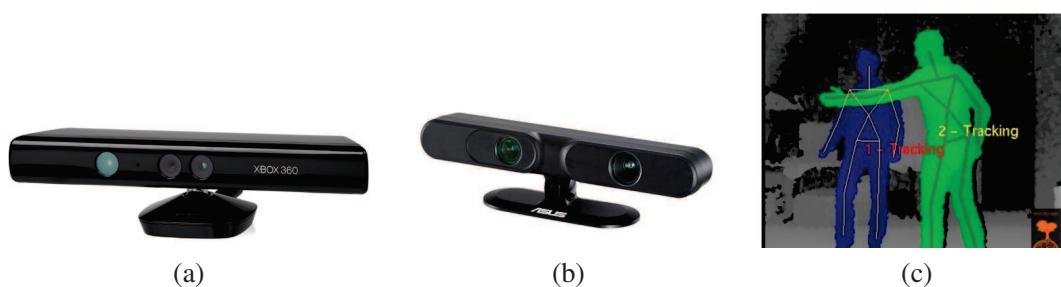
FIGURE 1.2.8 – Capteurs Kinect en (a) et Asus XTion en (b). En (c), les deux utilisateurs ont été détectés et modélisés dans l'image de profondeur.
