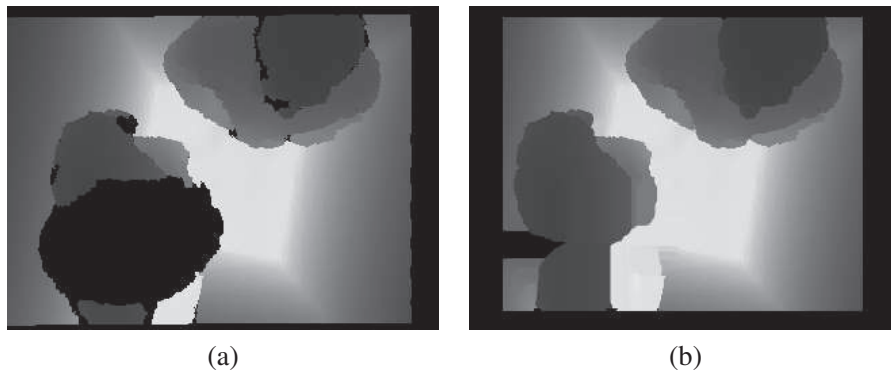
FIGURE 2.2.4 – En (a) l'image originale et en (b) l'image de résultat avec l'algorithme proposé dans [86]. La tête n'est pas correctement reconstruite.
