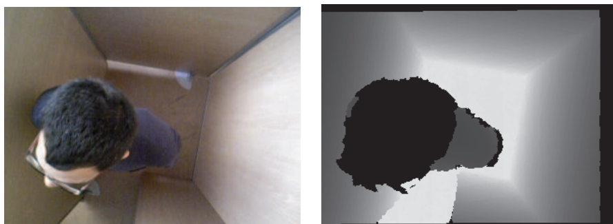
FIGURE 2.2.2 – Image couleur et de profondeur provenant du système de suivi. Les pixels du bras appartiennent à la première catégorie de pixels indéterminés et ceux de la tête font partie de la seconde.
