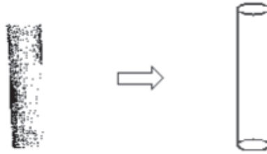
FIGURE 1.3.8 – Les données sont ajustées par un modèle de cylindre.
