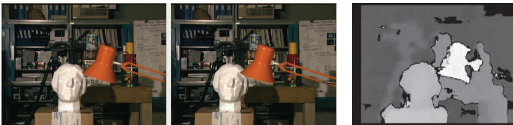
FIGURE 1.2.4 – Images couleurs et carte de profondeur obtenue avec les outils proposés par OpenCV.
