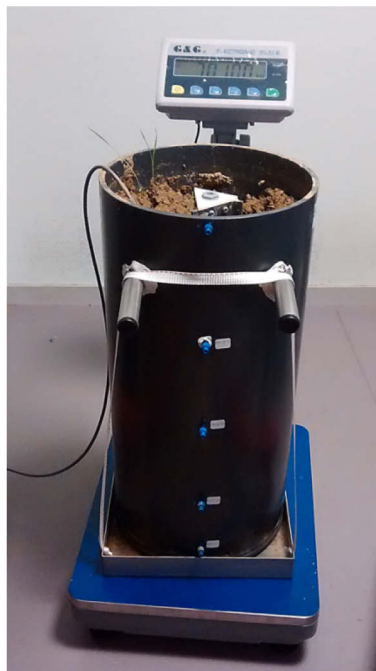
Figure 111 : Photo du banc d'essai positionné sur la balance. Les connecteurs des lysimètres apparaissent en bleu le long du tube.
