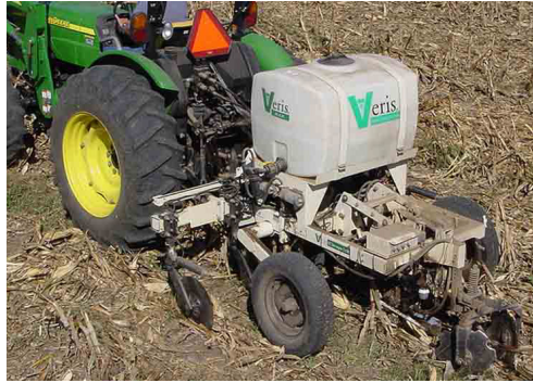
Figure 25 : Le soil pH Manager , produit commercialisé par Veris Technologies et permettant de cartographier la variabilité du pH sur une parcelle. Tiré de [114]
