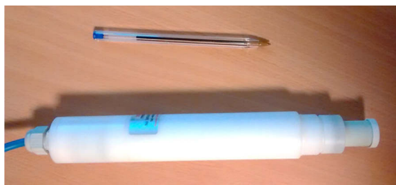
Figure 106 : Photo de l'électrode WE200 commercialisée par Silvion Limited. La jonction poreuse correspond à la zone de couleur gris-vert située sur la droite.
