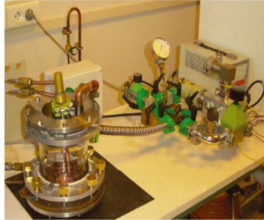
Fig. 2. 1. Schéma du four à arc (gauche), photographie du four à arc (droite).
