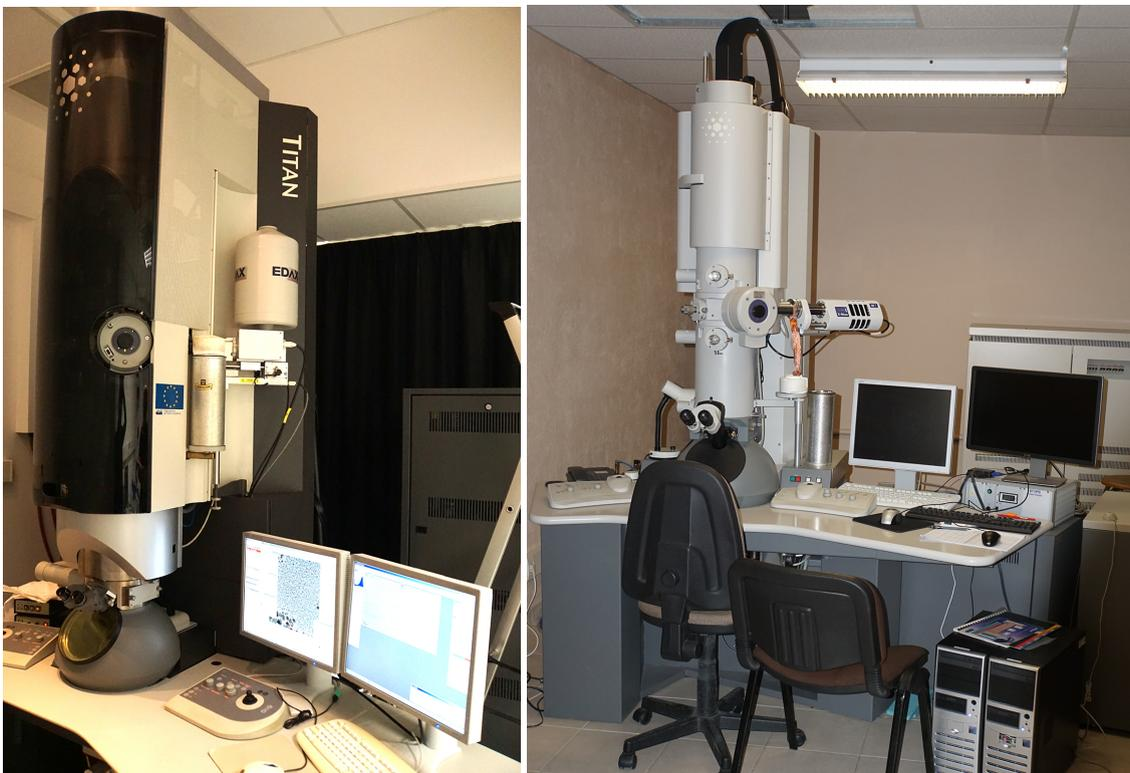
Fig. 2. 11. Image du microscope électronique en transmission TITAN (gauche) et TECNAI (droite).
