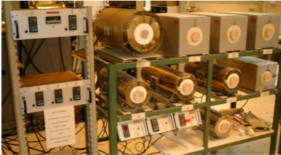
Fig. 2. 4. Fours tubulaires à résistance.
