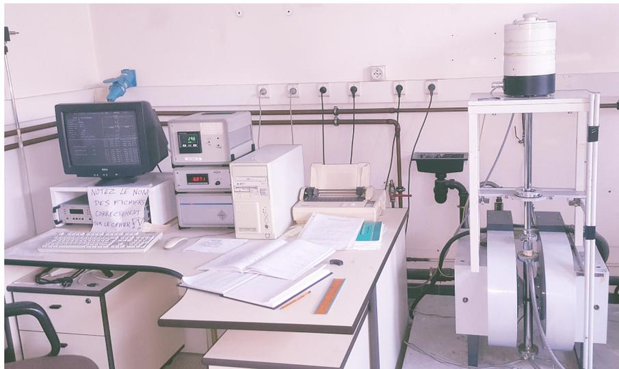
Fig. 2. 14. Photographie du magnétomètre différentiel DSM8.
