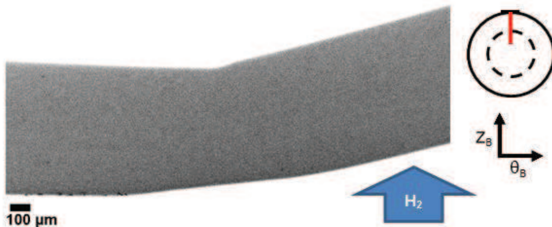
Figure III.2.12. Absence de fissuration dans le grade SiC 800 (disque V2D6.2) dans une section radiale où r_d est colinéaire à Z_B .
