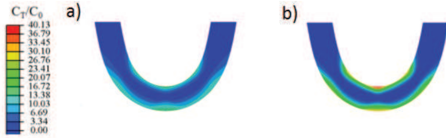
Figure I.4.11. Concentration d'hydrogène piégé pour deux relations C_L-C_T : a) relation saturante et b) relation linéaire [38].
