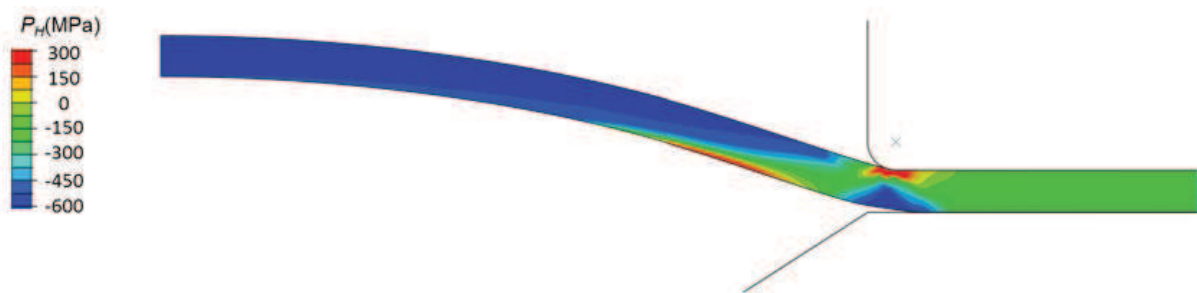
Figure V.3.3. Distribution de la pression hydrostatique dans l'ensemble du disque à 35 MPa.
