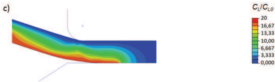
Figure V.3.1. Cartographies iso-valeurs de la concentration normalisée d'hydrogène diffusif dans la zone de rupture potentielle à différentes pressions : a) 15 MPa, b) 25 MPa et c) 35 MPa.
