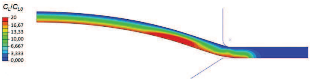
Figure V.3.2. Distribution de la concentration normalisée d'hydrogène diffusif dans l'ensemble du disque à 35 MPa.
