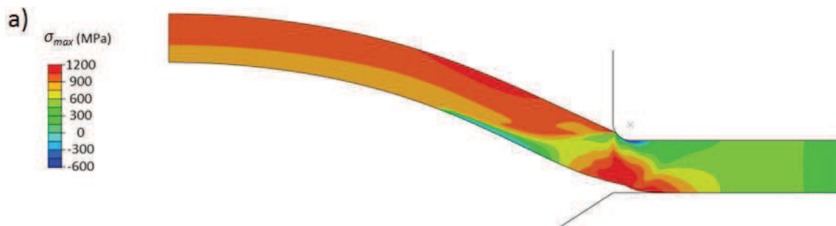
Figure IV.2.5. Cartographies iso-valeurs dans le disque d'épaisseur 1,50 mm à P'_{ruptH_2} = 54 MPa : a) \sigma_{max} et b) \epsilon_{eq} .
