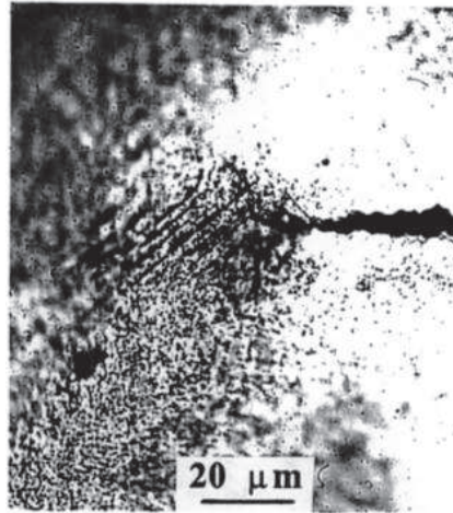
Figure I.1.3. Distribution de tritium en tête de fissure sur des monocristaux déformés d'un superalliage à base nickel [8].
