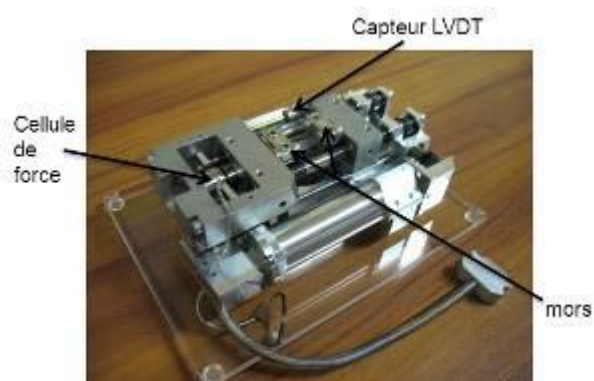
Figure II-14. Banc de traction in-situ sous MEB
