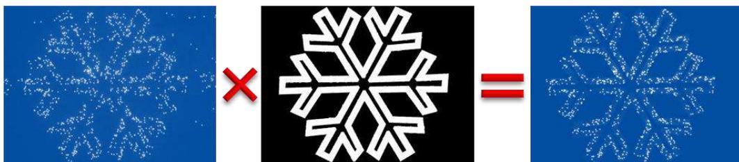
**Figure 4.9** Méthode de sélection des particules déposées sur les motifs de charges uniquement.
