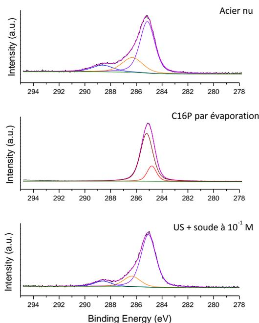
Figure 11.7 : Spectres XPS C1s pour l'acier nu et modifié par des couches de C16P obtenues par évaporation du solvant. Rouge clair : composante C-H,C-C, rouge foncé : composante C-H,C-C des multicouches, orange : composante C-OH, bleu : composante O-C=O et magenta : superposition des composantes. La composante violette correspond aux C-H,C-C ne provenant pas de C16P.
