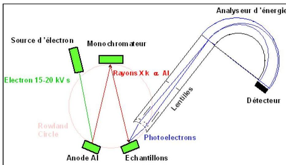
Figure annexe 2: Représentation schématique d'un spectromètre XPS.
