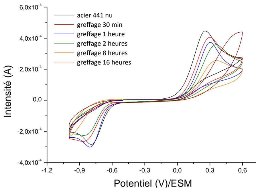
Figure 10.2 : Voltammétrie cyclique dans une solution aqueuse ( $10\text{mM Fe(CN)}_6^{4-} + 0,2\text{M LiClO}_4$ ) pour l'acier 441 nu et l'acier immergé dans une solution aqueuse de C4P. Balayage à  $100\text{ mV/s}$ .
