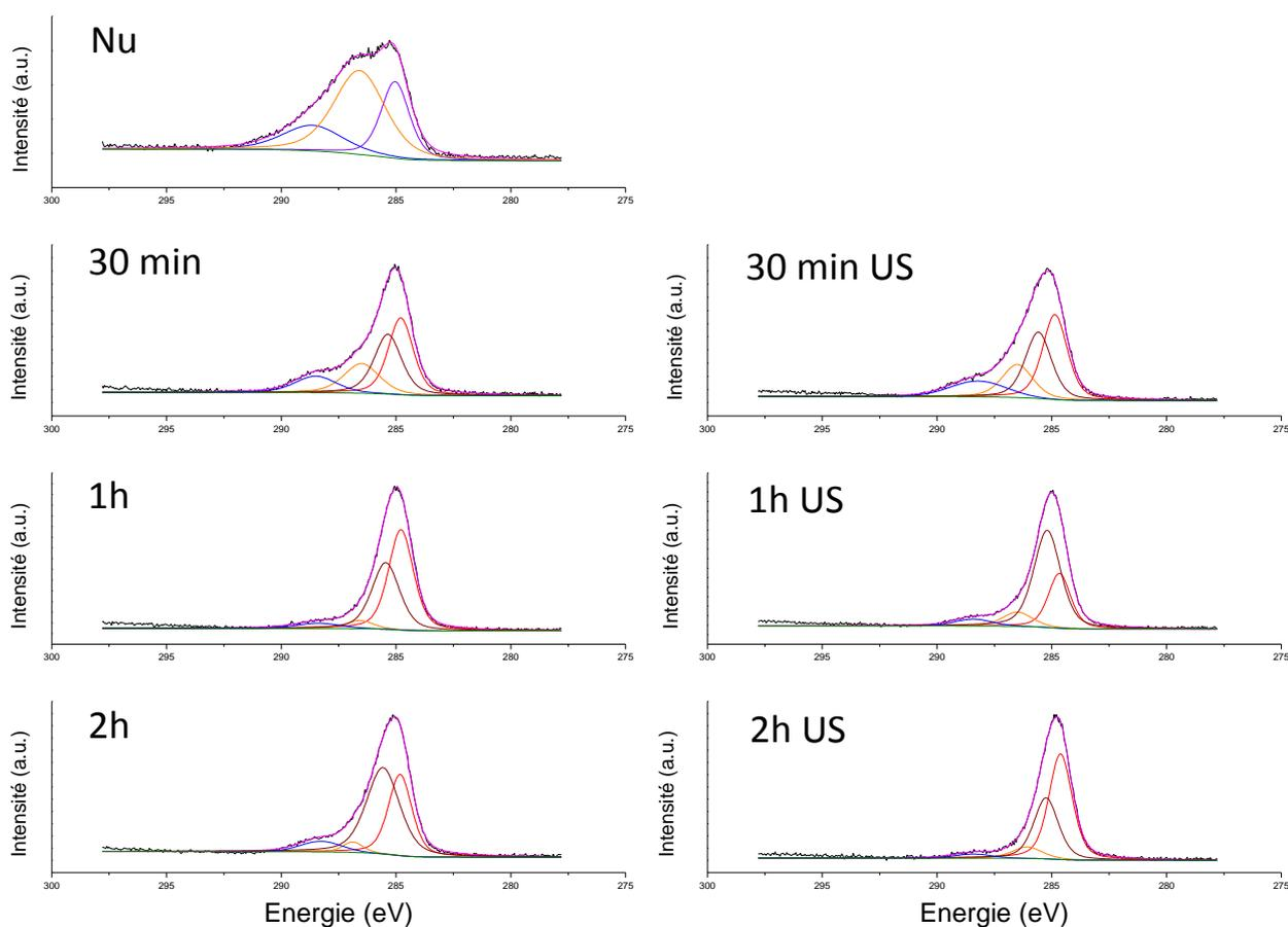
Figure 8.8 : Spectres XPS C1s pour l'acier nu et modifié par l'acide C16P pendant 30 min, 1 heure et 2 heures dans des conditions silencieuses et sous irradiation ultrasonore. Rouge clair : la composante C-H,C-C, rouge foncé : la composante
