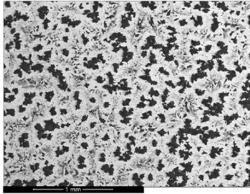
Figure 9.2 : Image MEB (grandissement  $\times 40$ , modes BSE) de la surface de l'acier K41 fonctionnalisé avec de l'acide C16P par évaporation.
