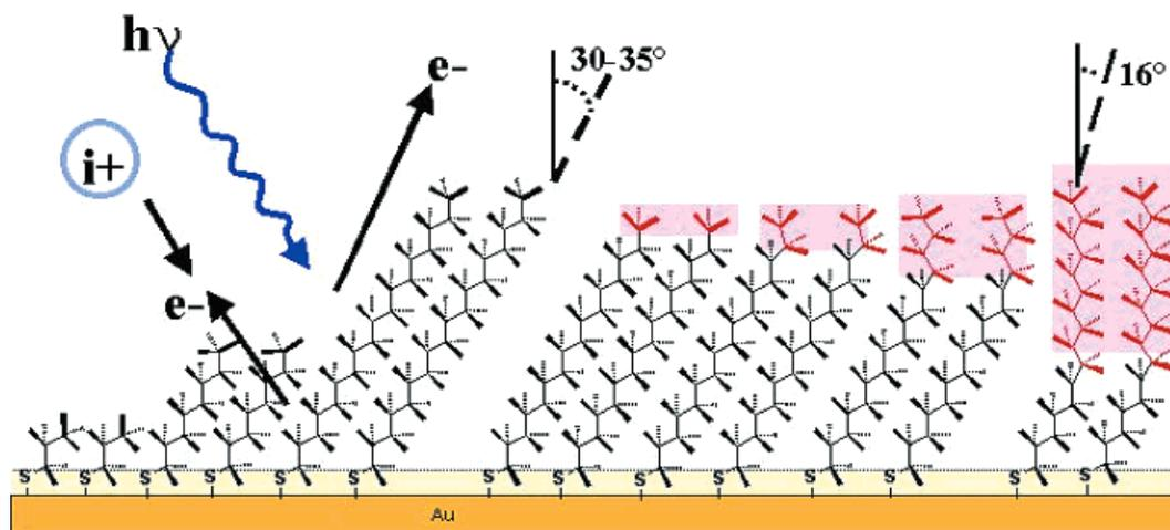
Figure 2.4 : Schéma de l'organisation des alcanethiols normaux ( $C_3SH$ ,  $C_8SH$  et  $C_{18}SH$ ) et des alcanethiols partiellement fluorés ( $F_\gamma C_{16-\gamma}SH$  avec  $\gamma = 1, 2, 4$  et  $10$ ) [24]
