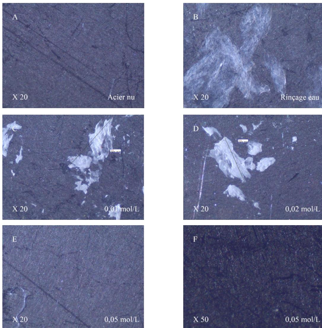
Figure 11.1 : Images par binoculaire (grossissement X 20) de l'acier nu (A), l'acier modifié par C16P et rinçage à l'eau (B), nettoyage à la soude à différentes concentrations (C, D et E). (F) Images (grossissement X 50) après modification et nettoyage à la soude à  $5 \times 10^{-2}$  M.
