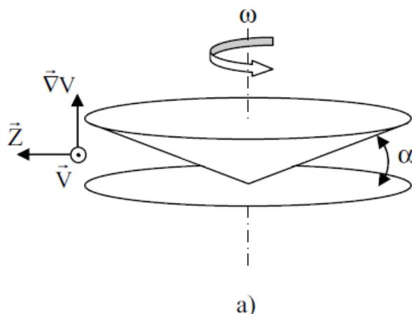
Figure 9.11 : Cellule de cisaillement en géométrie cône-plan [173].
