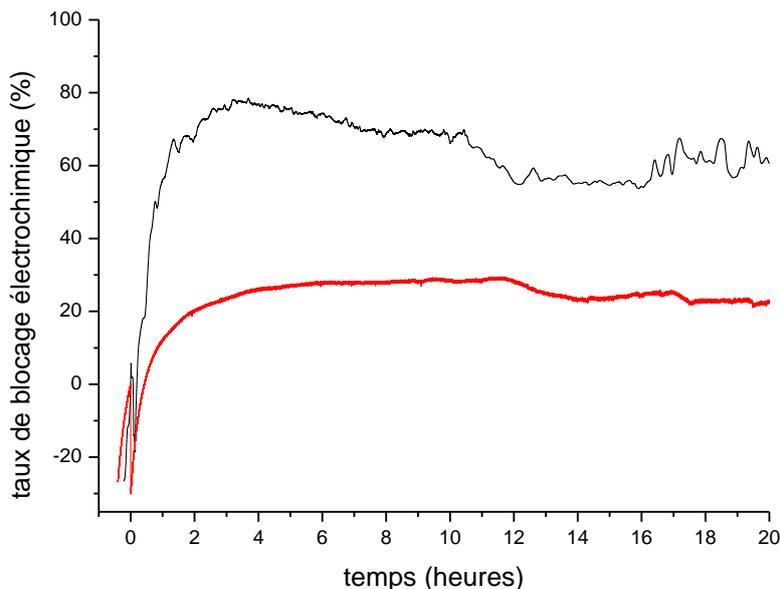
Figure 10.3 : Taux de blocage électrochimique (équation (33)) lors du suivi du greffage par chronoampérométrie en milieu (10mM Fc + 0,2M LiClO<sub>4</sub>) éthanolique (en noir) et (10mM Fe(CN)<sub>6</sub><sup>4-</sup> + 0,2M LiClO<sub>4</sub>) aqueuse (en rouge) pour l'acier 441.
