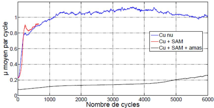
Figure 4.3 : évolution du coefficient de frottement moyen sur tribomètre pion-plan pour le cuivre nu (bleu) et le cuivre fonctionnalisé avec (gris) et sans (rouge) agrégats (amas). Amplitude de frottement de 1mm, vitesse de 1mm/sec, force normale de 0,2 N et bille en nitrure de silicium de diamètre de 20 mm [96].
