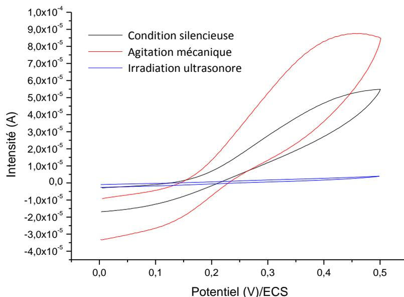
Figure 7.13 : Voltammogramme dans une solution aqueuse ( $10 \text{ mM Fe(CN)}_6^{4-} + 0.2 \text{ M Na}_2\text{SO}_4$ ) pour les échantillons d'or modifiés pendant 3 heures en condition silencieuse (noir), sous agitation mécanique (rouge) et sous irradiation ultrasonore haute fréquence (bleu). Vitesse de balayage de  $100 \text{ mV/s}$ .
