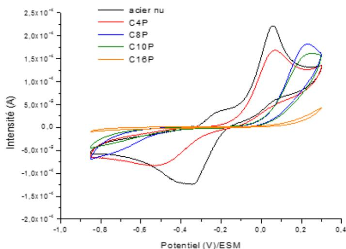
Figure 8.4 : Voltamétries cycliques dans une solution aqueuse de 5 mM  $K_4Fe(CN)_6$  + 0,2 M  $Na_2SO_4$  pour l'acier nu (noir) et les échantillons modifiés pendant 8 heures par du C4P (rouge), du C8P (bleu), du C10P (vert) et du C16P (orange). Vitesse de balayage : 100mV/s
