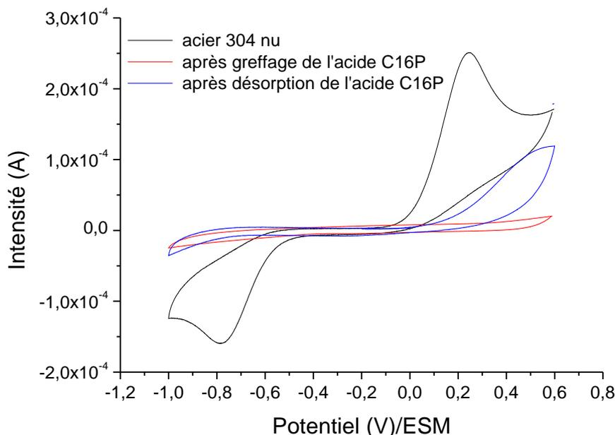
Figure 11.2 : Voltammétries cycliques en solution ( $10\text{mM Fe(CN)}_6^{4-} + 0,2\text{M Na}_2\text{SO}_4$ ) aqueuse pour l'acier 304 nu et l'acier modifié avant et après désorption des C16P par une solution de soude ( $0,1\text{ M}$ ) à  $55^\circ\text{C}$ . Balayage à  $100\text{ mV/s}$ .
