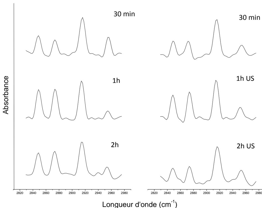
Figure 8.7 : Spectre infrarouge des échantillons modifiés par les C16P en condition silencieuse et sous irradiation ultrasonore.
