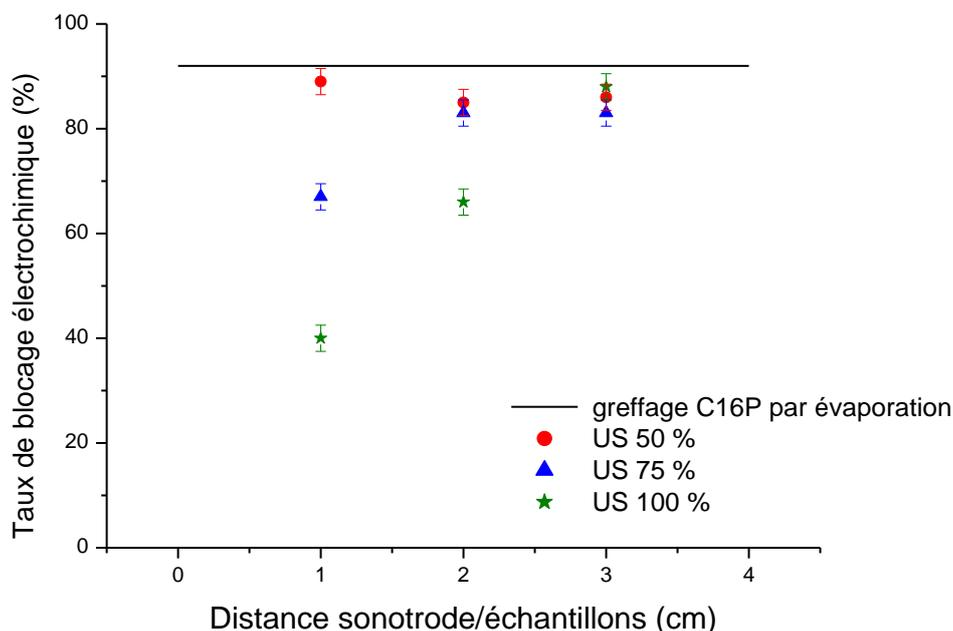
Figure 11.5: Evolution du taux de blocage électrochimique ( $\pm 2\%$ ), suivant la distance sonotrode/échantillon, les échantillons ont subi un traitement par ultrasons dans l'eau à trois amplitudes vibratoires (50, 75 et 100 %), après greffage de C16P par évaporation. La ligne noire correspond au taux de blocage moyen pour les couches de C16P formées.
