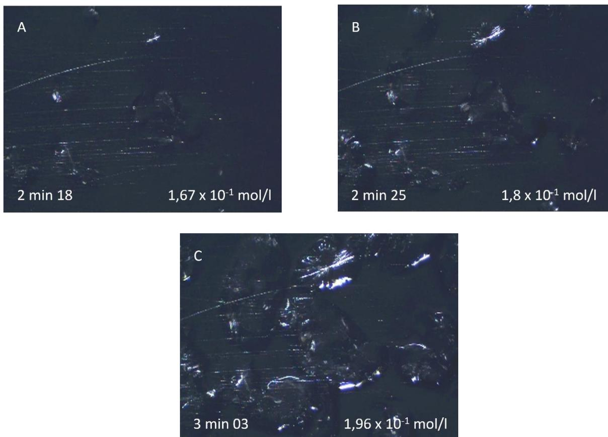
Figure 9.6 : Images, par microscopie optique, de la croissance des agrégats dans une solution de modification de C16P (concentration de départ  $5 \times 10^{-2}$  M). Grossissement  $\times 20$ .
