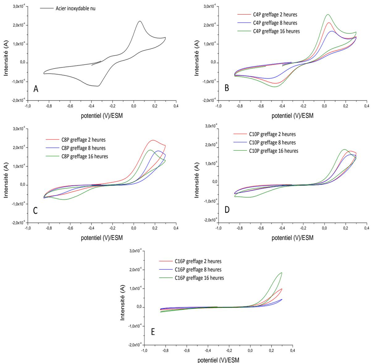
Figure 8.3 : Voltamétries cycliques dans une solution aqueuse (5mM  $K_4Fe(CN)_6$ + 0,2M  $Na_2SO_4$ ) de A) l'acier inoxydable nu, B) l'acier 304L modifié avec du C4P, C) l'acier 304L modifié avec du C8P, D) l'acier 304L modifié avec du C10P, E) l'acier 304L modifié avec du C16P.. Vitesse de balayage : 100mV/s.
