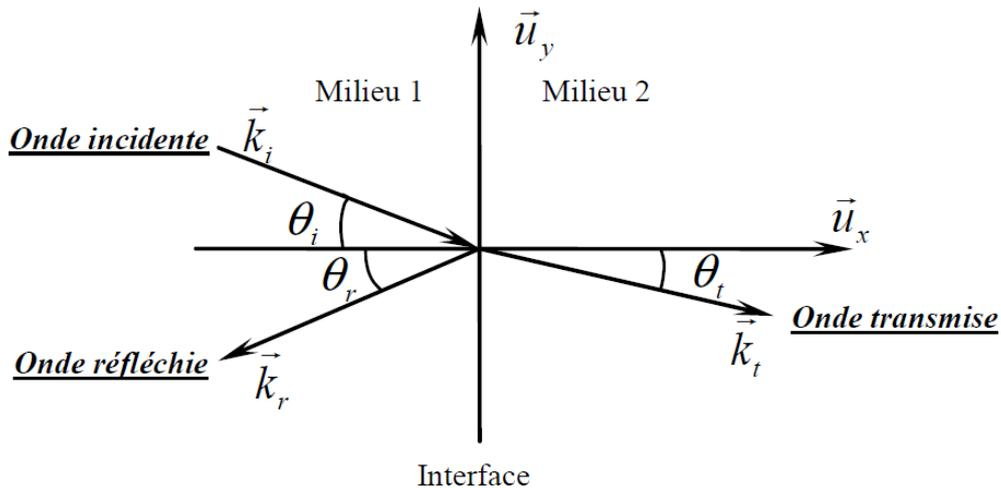
Figure 6.5 : réflexion et transmission d'une onde progressive incidente.
