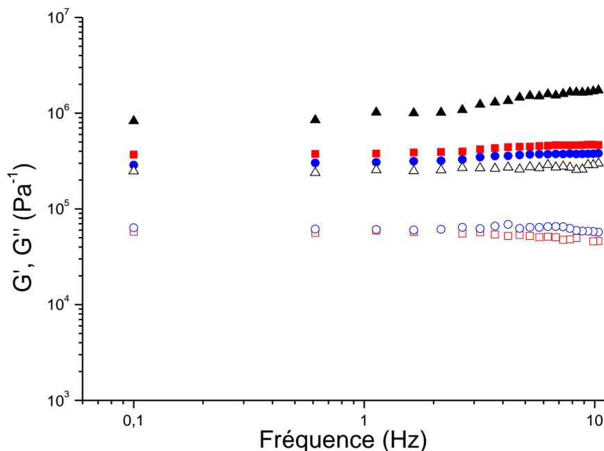
Figure 9.14 : Modules de stockage  $G'$  (plein) et de perte  $G''$  (creux) en fonction de la fréquence angulaire des phases lamellaires à 20 ° C. Solutions à des concentration en C16P à  $1,5 \times 10^{-1}$  (carré rouge),  $2 \times 10^{-1}$  (rond bleu) et  $3 \times 10^{-1}$  M (triangle noir).
