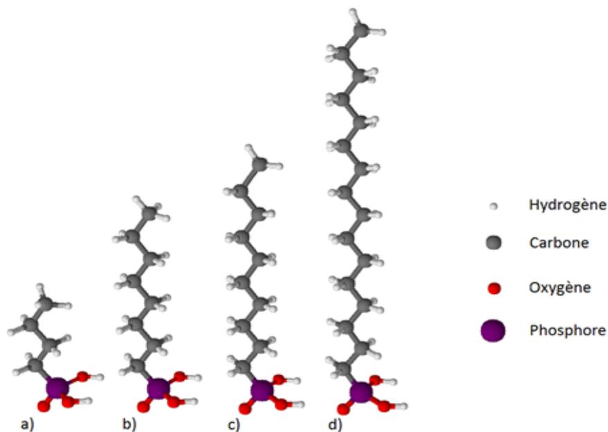
Les chaînes carbonées des couches auto-assemblées isolent la surface du substrat. Cette isolation dépend fortement de la structure de la couche greffée et de la compacité de cette dernière. Cependant, même à travers une SAM exempte de défauts et recouvrant entièrement la surface, les électrons peuvent être acheminés par effet tunnel. Ce courant est atténué par l'épaisseur (et donc la longueur de chaîne) du dépôt. En ce qui concerne les multicouches,
