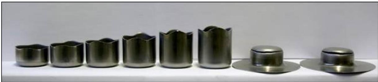
Figure 4.5 : (A) Evolution du coefficient de frottement moyen en fonction du nombre de cycles (B), godets obtenus par emboutissage d'acier inoxydable, lubrifié par C16P [5 x 10<sup>-2</sup> M]
