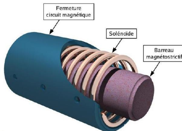
Figure 6.2 : représentation 3D d'un transducteur piézomagnétique.[123]
