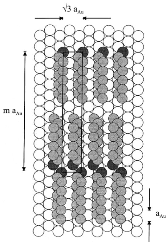
Figure 2.5 : Schéma 2D de la structure formée par les molécules d'alcanethiol lors de la première étape d'auto-assemblage [26].
