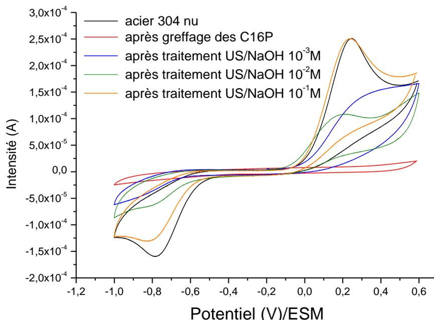
Figure 11.6 : Voltammétries cycliques en solution aqueuse (10mM Fe(CN)<sub>6</sub><sup>4-</sup> + 0,2M Na<sub>2</sub>SO<sub>4</sub>) pour l'acier 304 nu, l'acier modifié par l'acide C16P et après désorption des couches de C16P par ultrasons basse fréquence dans des solutions de soude à 10<sup>-1</sup>, 10<sup>-2</sup> et 10<sup>-3</sup> M. Balayage à 100 mV/s.
