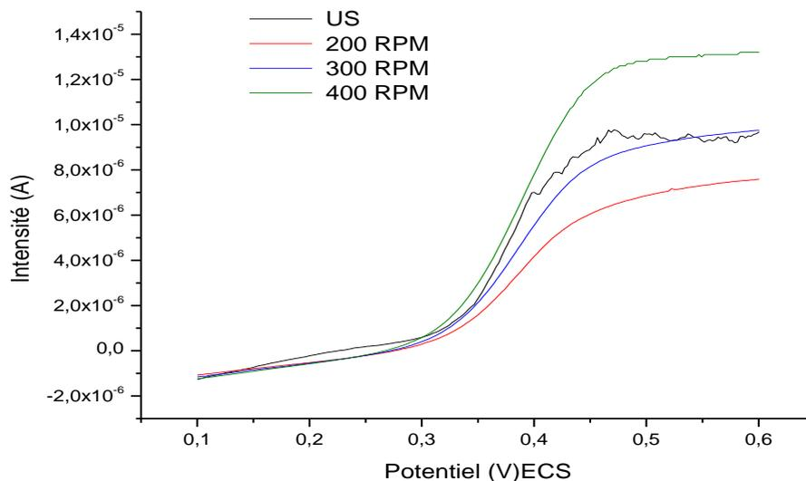
Figure 7.4 : polarisation anodique d'une électrode d'or sous US haute fréquence (noir) ou sous agitation mécanique à 200 (rouge), 300 (bleu) et 400 RPM, dans une solution à  $10^{-2}$  M de ferrocène et 0,1 M de perchlorate de lithium dans EtOH. Vitesse de balayage : 1 mV/s.
