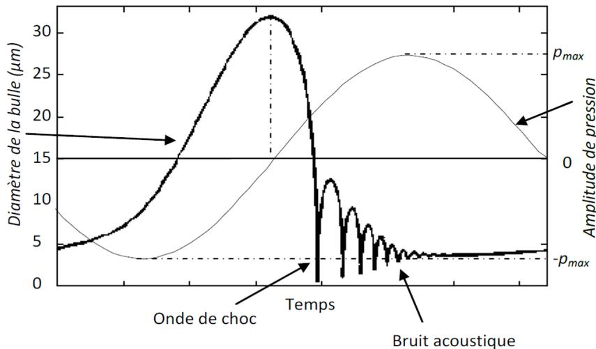
Figure 6.8 : Evolution du rayon d'une bulle de cavitation inertielle sur une période de l'onde acoustique [134]
