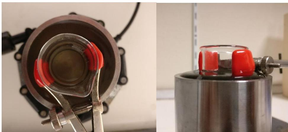
*Figure 7.1 : dispositif expérimentale avec le bécher immergée dans le sonoréacteur multifréquence.*
