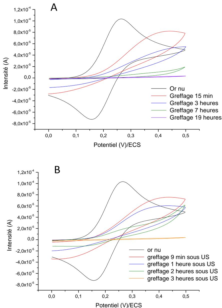
Figure 7.9 : Voltammogramme dans une solution aqueuse ( $10 \text{ mM } Fe(CN)_6^{4-} + 0,2 \text{ M } Na_2SO_4$ ) pour l'or nu et l'or modifié avec des C11SH en condition silencieuse (A) et sous irradiation ultrasonore (B). Balayage à  $100 \text{ mV/s}$
