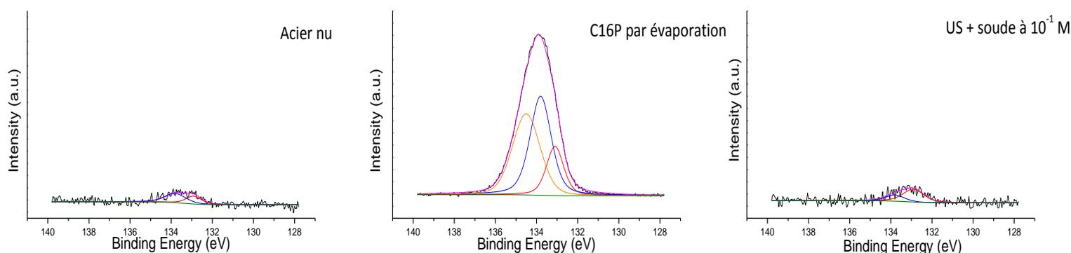
Figure 11.8 : Spectres XPS P2p pour l'acier nu et modifié par des couches de C16P obtenues par évaporation du solvant. Rouge clair : composante P-O-M, bleu : composante  $PO(OH)_2$  et magenta : superposition des composantes. Un nouveau signal apparaît en orange dans le spectre des couches de C16P obtenues par évaporation du solvant.
