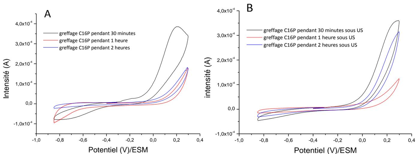
Figure 8.6 : Voltamétries cycliques dans une solution aqueuse (5 mM  $K_4Fe(CN)_6$  + 0,2M  $Na_2SO_4$ ) pour l'acier 304L nu et l'acier modifié avec de l'acide C16P en condition silencieuse (A) et sous irradiation ultrasonore (B). Balayage à 100 mV/s
