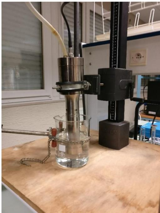
Figure 11.3 : montage pour la désorption des molécules de C16P par ultrasons
