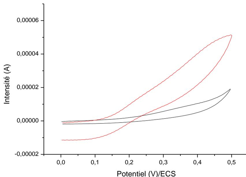
Figure 7.14 : Voltammétries cycliques dans une solution aqueuse (10 mM  $\text{Fe}(\text{CN})_6^{4-}$  + 0.2 M  $\text{Na}_2\text{SO}_4$ ) pour les échantillons d'or modifiés pendant 7 heures en condition silencieuse (noir), sous agitation mécanique (rouge). Vitesse de balayage de 100 mV/s.
