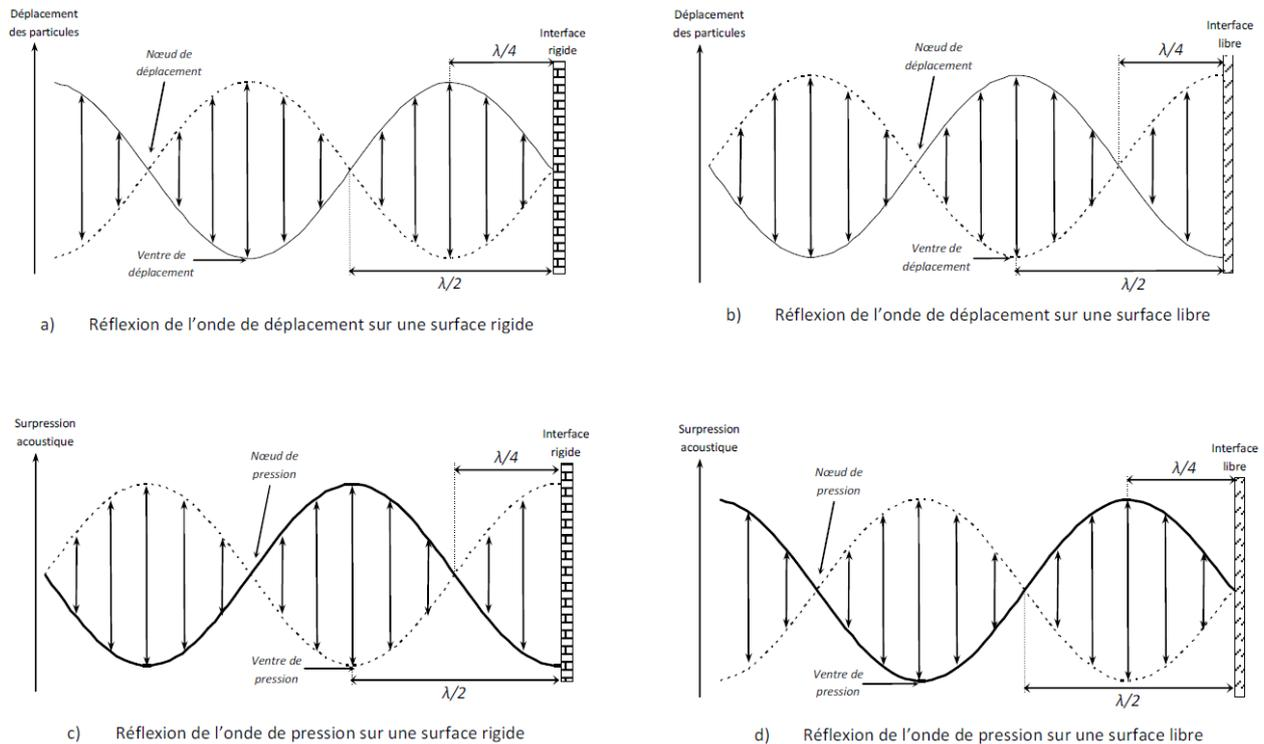
Figure 6.6 : Établissement d'une onde stationnaire par réflexion de l'onde de déplacement (a,b) et de l'onde de pression (c,d) sur une interface rigide ou libre [124].
