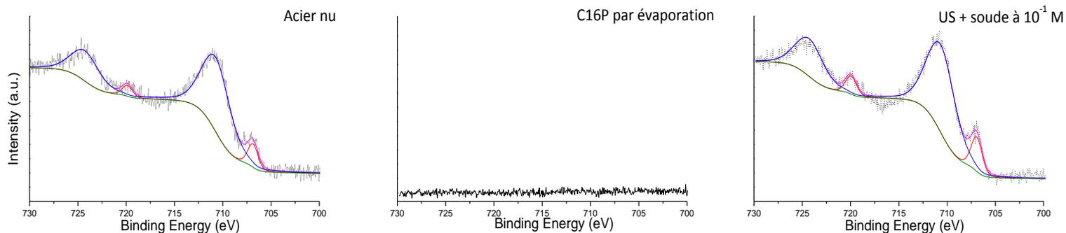
Figure 11.9 : Spectres XPS Fe2p pour l'acier nu et modifié par des couches de C16P obtenues par évaporation du solvant. Rouge clair : composante Fe, bleu : composante Fe<sub>2</sub>O<sub>3</sub> et magenta : superposition des composantes.
