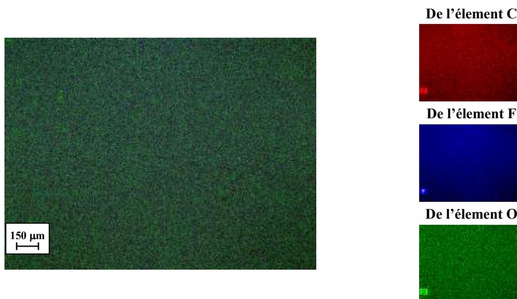
Figure 54. Cartographies des éléments C, F et O réalisée par MEB via un détecteur EDS de la surface de l'échantillon F\_LDPE\_FS.
