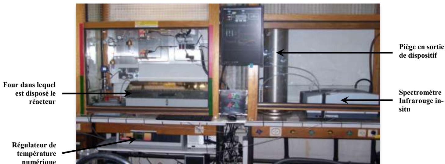
Figure 27. Dispositif expérimental automatisé utilisé pour les procédés de fluoration directe en conditions statiques.
