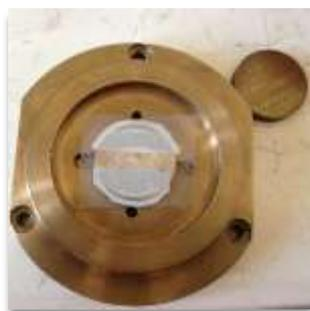
Figure 71. Support d'analyse du dispositif tribomètre.
