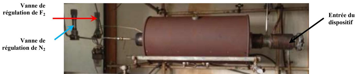
**Figure 38.** Dispositif de fluoration utilisée pour les procédés de fluoration directe en conditions dynamiques à température ambiante à partir d'une atmosphère fluorée diluée N<sub>2</sub>/F<sub>2</sub> (0,5/0,5 volumique).
