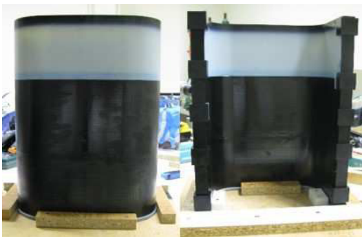
Figure D- 2 : Moule du RIG réduit réalisé à l'aide de l'impression 3D. Il comporte 22 pièces.
