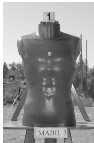
Figure 1.41 : Mannequin canadien MABIL, substitut du thorax humain (50th percentile). Ce mannequin est réalisé en élastomère de polyuréthane (PMC 870).
