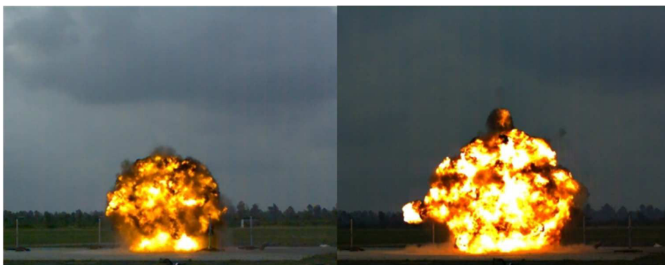
Figure 2.4 : Visualisation de la boule de feu après la détonation de 2kg de C4 à 133cm ( gauche ) et de 5kg de C4 à 133cm ( droite )
