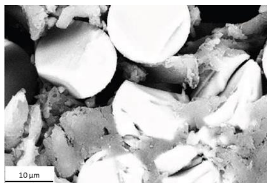
Figure 1.31 : Image MEB de fibres de verre fissurées suite à une sollicitation de l'interface
