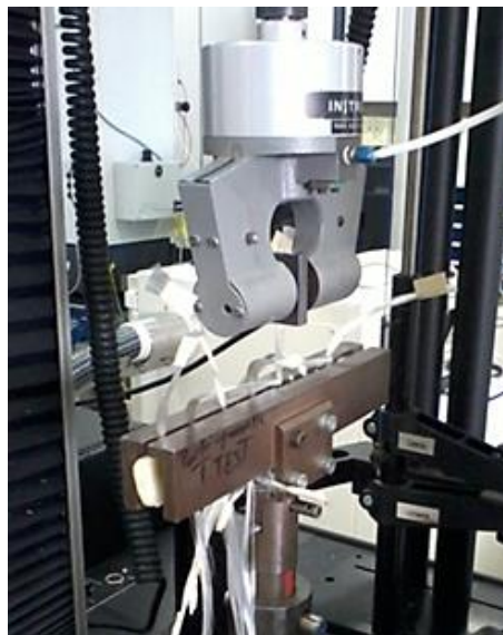
Figure 2.20 : Schéma du montage pour la tenue à l'arrachement T-Test
