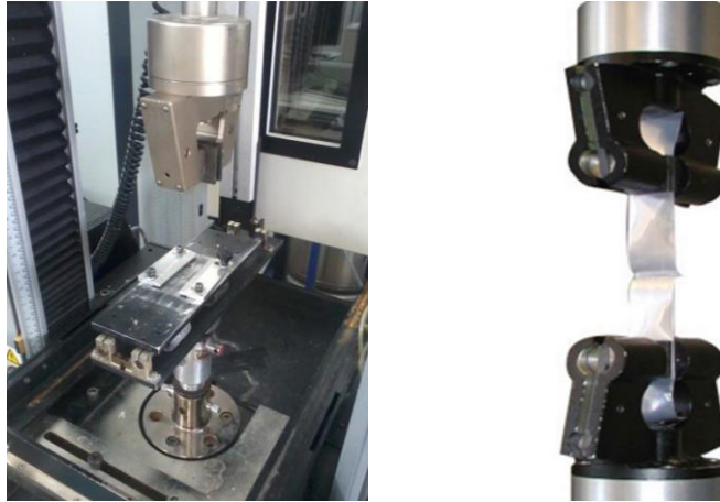
Figure 2.12: Exemples de montage avec banc de pelage 90° (gauche) et système de pelage 180° (droite)
