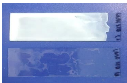
Figure 4.2: Couche de PA12 sur une lame de verre: après l'évaporation de l'AF/DCM (haut), après l'évaporation du m-crésol (bas)
