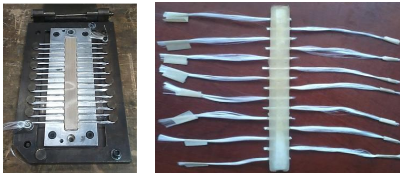
Figure 2.22 : Préparation de l'éprouvette : mèche tendue entre deux séries de films PA (gauche), éprouvette après sortie du moule et découpe de mèches (droite)
