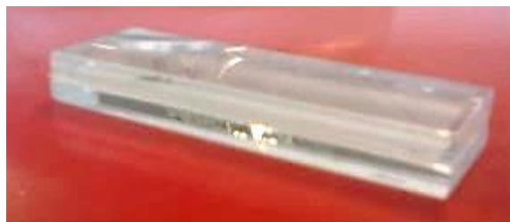
Figure 2.19 : Échantillon représentatif d'un assemblage en sandwich de deux lames de verre traitées (5 mm)
