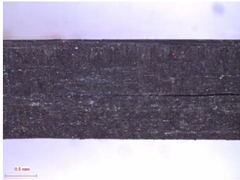
Figure 1.26 : Image par microscopie optique : rupture en cisaillement interlaminaire simple
