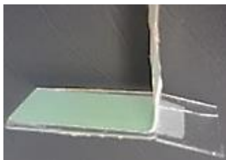
Figure 3.34 : Rupture cohésive au sein de la matrice suite au test de pelage
