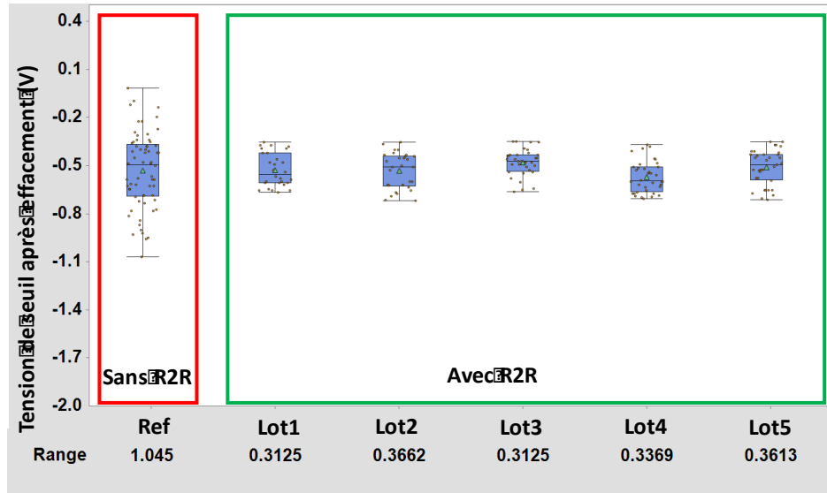
Figure 4.19 : Dispersion du V_{TE} pour les lots avec ou sans boucle de régulation
