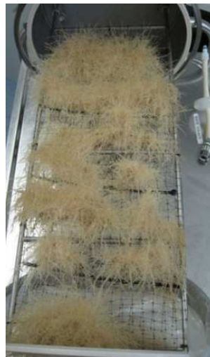
Figure 1.37 : Bioréacteur spécifique pour les hairy roots (Peak et al., 2014)
