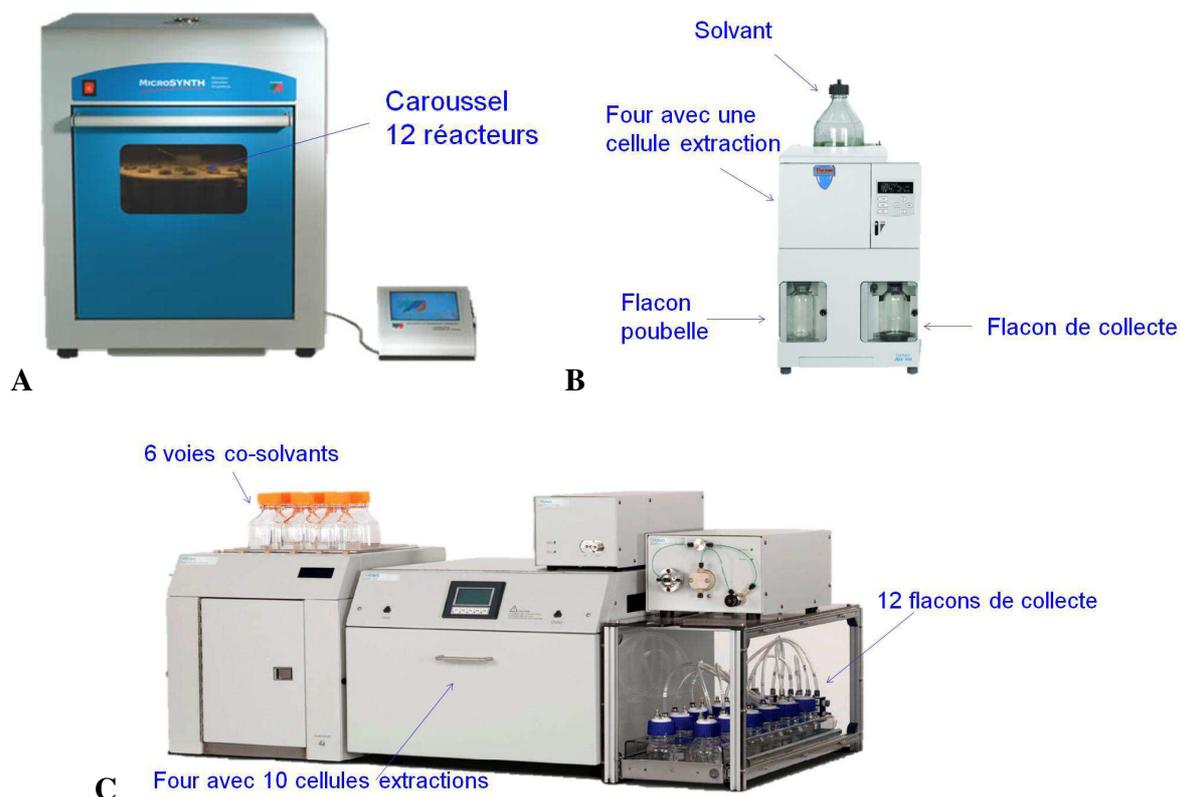
**Figure 3.18 : Les différents appareils utilisés pour l'extraction**
