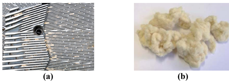
Figure 32 : vue de face d'un disque de raffineur (a), fibre de bois en sortie de raffineur (b)
