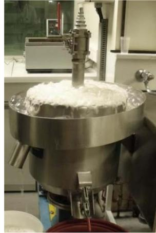
Figure 35 : dispositif de flottation Kardant
