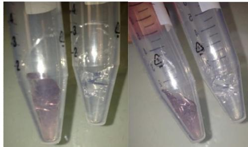
*Figure 165 : Photos des matériaux obtenus avec gélification en centrifugation, le matériau blanc étant bien sûr l'incolore et le violet le dopé en bipyramides*
