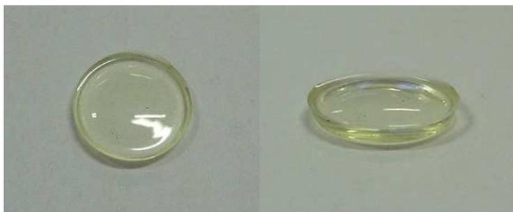
Figure 129 : Photos d'un matériau dopé en PtTFb à une concentration de 10mM
