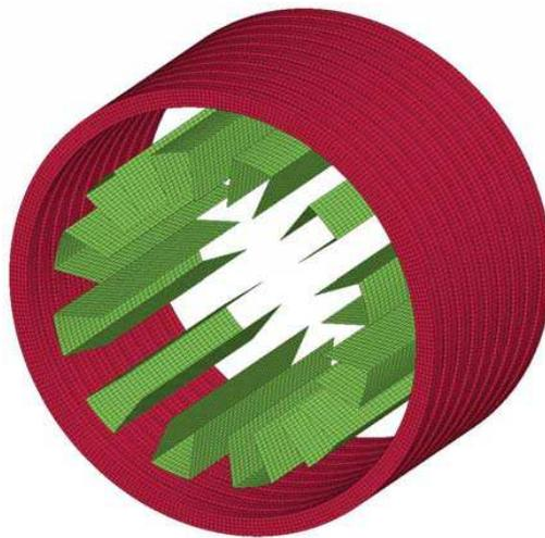
FIGURE 3.10 – Modèle EF du circuit d'eau et du bobinage
