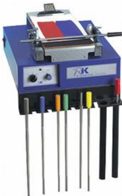
Figure A - 3 : Applicateur de films automatique Erichsen et ses filmographes [1]
