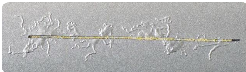
Figure I - 6 : Corrosion filiforme sur un échantillon d'aluminium peint et scarifié
