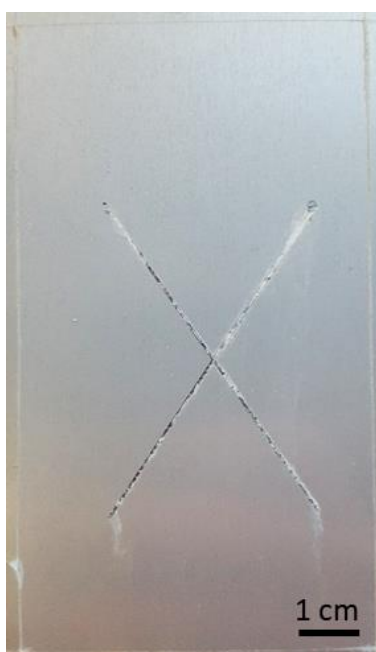
Figure I - 29 : Substrat en alliage d'aluminium 2024-T3 revêtu du revêtement hybride sol-gel/polymère contenant l'inhibiteur de corrosion, après 3000 heures de brouillard salin continu
