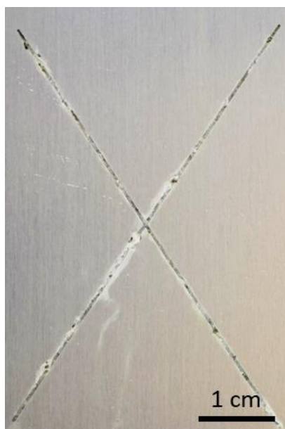
Figure IV - 36 : Résultat BS d'un substrat en alliage d'aluminium 2024-T3 revêtu par le revêtement hybride sol-gel/polymère contenant le strontium aluminium polyphosphate hydraté ( 25 \pm 2 \mu\text{m} ) après 3000 heures
