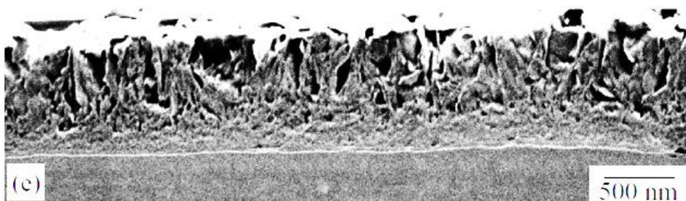
**Figure I - 15 : Images MEB vue en coupe de la zone blessée sur un alliage d'aluminium 2024-T3 revêtu d'un film contenant du carbonate de lithium, après 168 h de brouillard salin neutre. Les 3 couches distinctes sont mises en évidence [108]**
