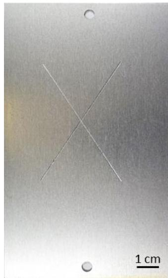
**Figure A - 6 : Blessure artificielle**
