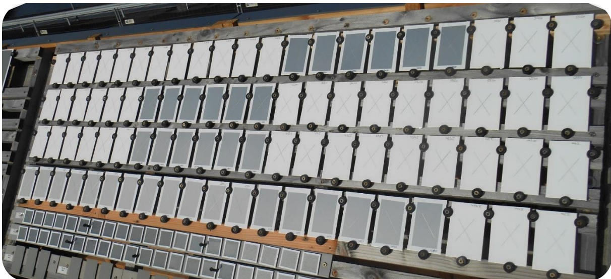
Figure II - 30 : Exposition des échantillons en alliage d'aluminium 2024-T3 revêtus à 45° Sud à Brest
