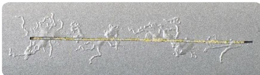
Figure I - 6 : Corrosion filiforme sur un échantillon d'aluminium peint et scarifié
