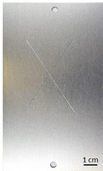
Figure II - 24 : Blessure artificielle sur un substrat en alliage d'aluminium 2024-T3
