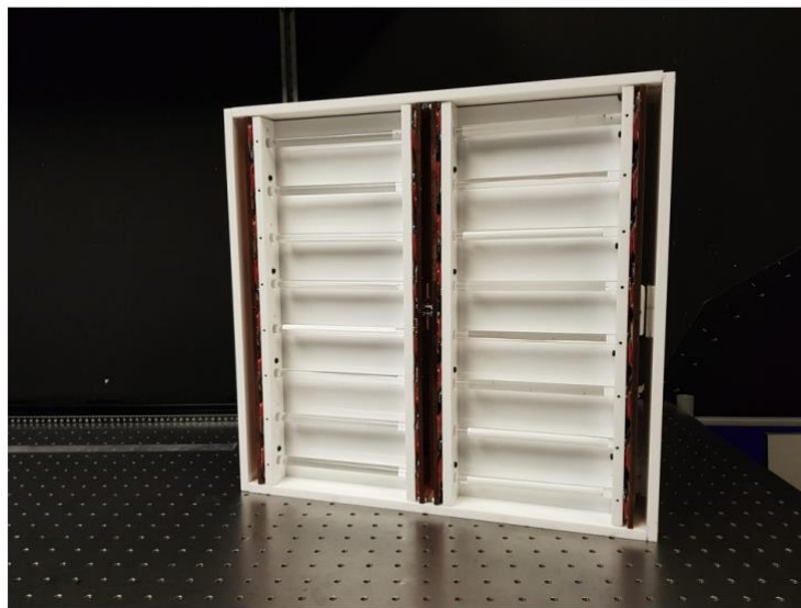
Figure 42 : Dispositif d'illumination en « lumière du jour artificielle » développé par O'Mahoney et al, d'après (149). Ce dispositif délivre une fluence efficace de 5,6\text{J}/\text{cm}^2 en 2h.
