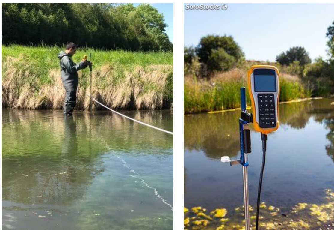
Photo 10: Mesures de débit en cours d'eau (opérateur F. Donati, Cliché: Q. Choffel) et courantomètre FlowTracker utilisé (Source: SoloStocks.com)
