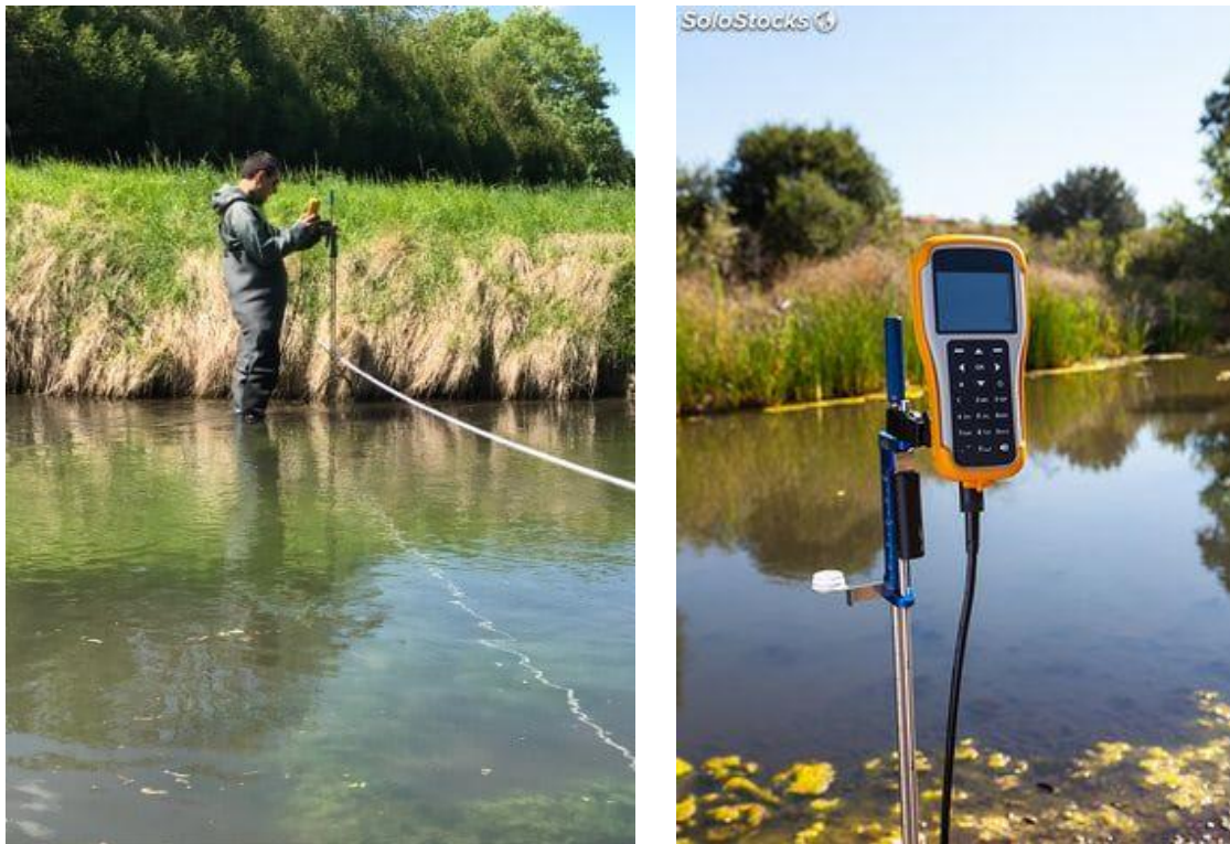
Photo 10: Mesures de débit en cours d'eau (opérateur F. Donati, Cliché: Q. Choffel) et courantomètre FlowTracker utilisé (Source: SoloStocks.com)
