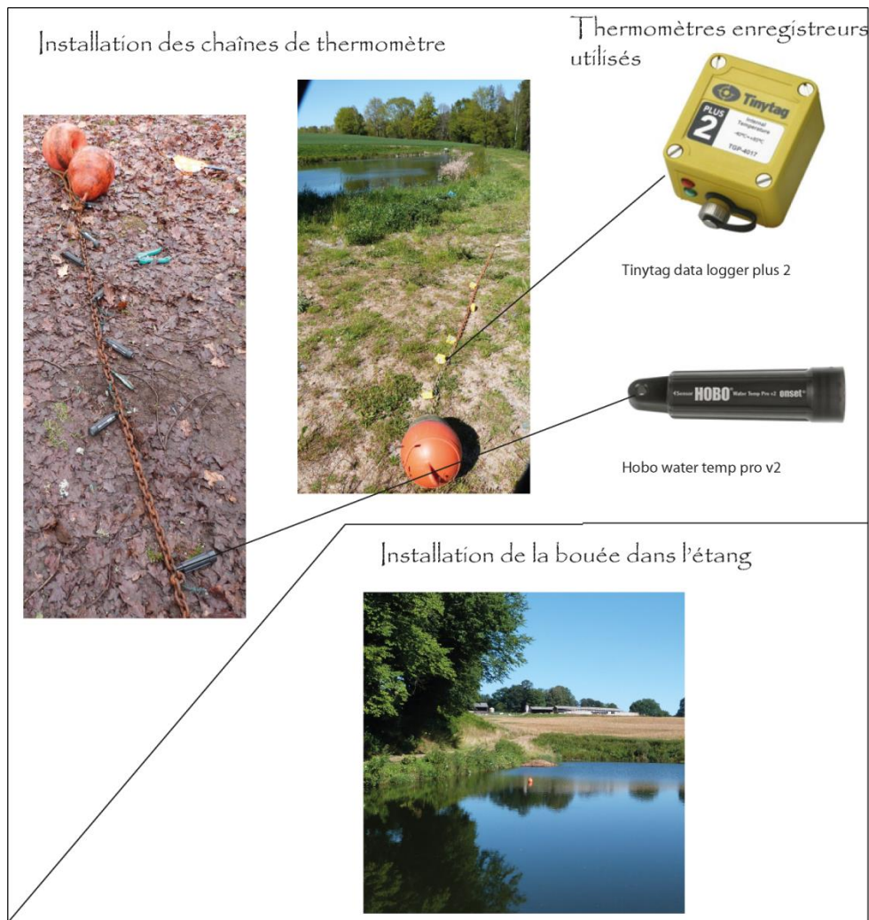
Figure 22: Méthodologie de mesures thermiques en continu. Q. Choffel, 2018
