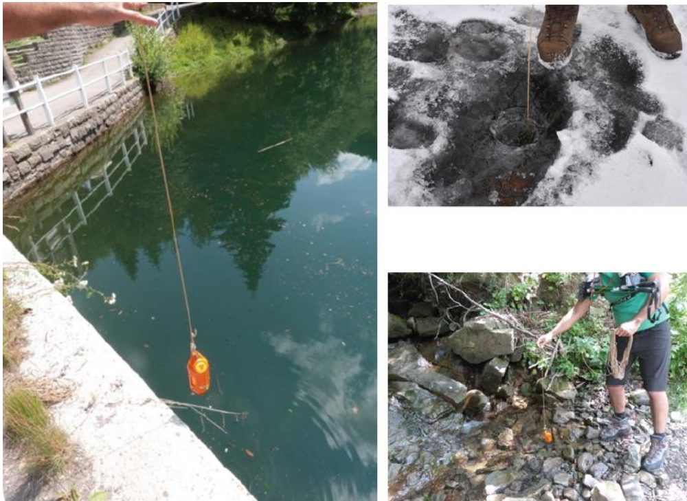
Photo 9: Mesures à l'aide du CastAway en lac gelé (en haut à droite), cours d'eau (en bas à droite) et en étang (gauche). Clichés: Q. Choffel, opérateurs: F. Donati et Q. Choffel, 2018.
