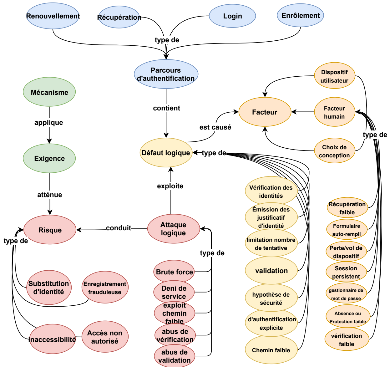
Figure 3.4 – Ontologie du parcours d’authentification avec les classes de défauts logiques et les exploitations correspondantes
