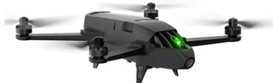
FIGURE A.4. – Drones à voilures tournantes à quatre rotors, Quadrirotor agricole Parrot Bluegrass.
