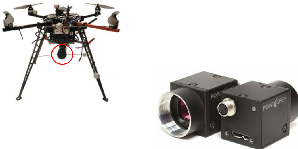
FIGURE 4.7. – Système complet : Quadrirotor utilisé avec caméra ( gauche ) et Caméra de type Point Grey Flea3 ( droite )
