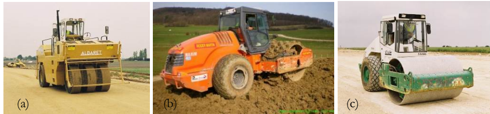
Figure 76 : exemple de compacteurs sur chantier : (a) compacteur à pneu, (b) vibrant pieds-dameurs, (c) vibrant monocylindre.
