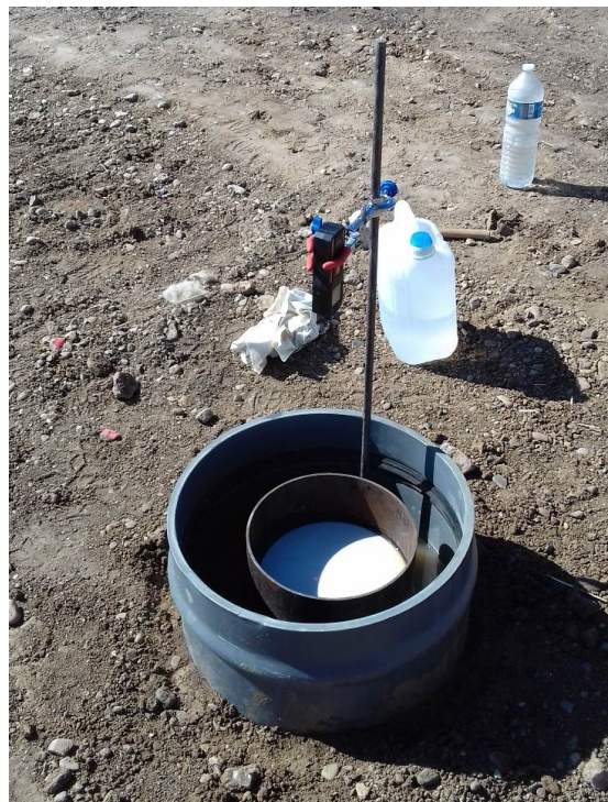
Figure 83 : Mesure au perméamètre à double anneau (digue de St Pryvé-St Mesmin, 2018). Le suivi du niveau d'eau est réalisé par un télémètre laser (dispositif pratiqué par le laboratoire Tranlabogéo)
