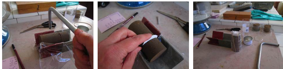
Figure 105 : Mesure de succion par la méthode du papier filtre (ASTM 5298) après compactage ou séchage, l'éprouvette est fendue en deux, les 3 disques de papier Whatmann 42 sont insérés puis l'éprouvette est soigneusement emballée pour conservation pendant 7 jours.
