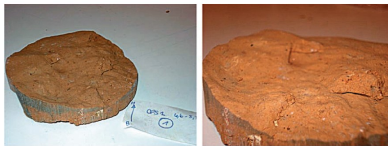
Figure 80 : Aspect de la discontinuité observée dans une carotte [du remblai expérimental] (Vinceslas et al., 2009)
