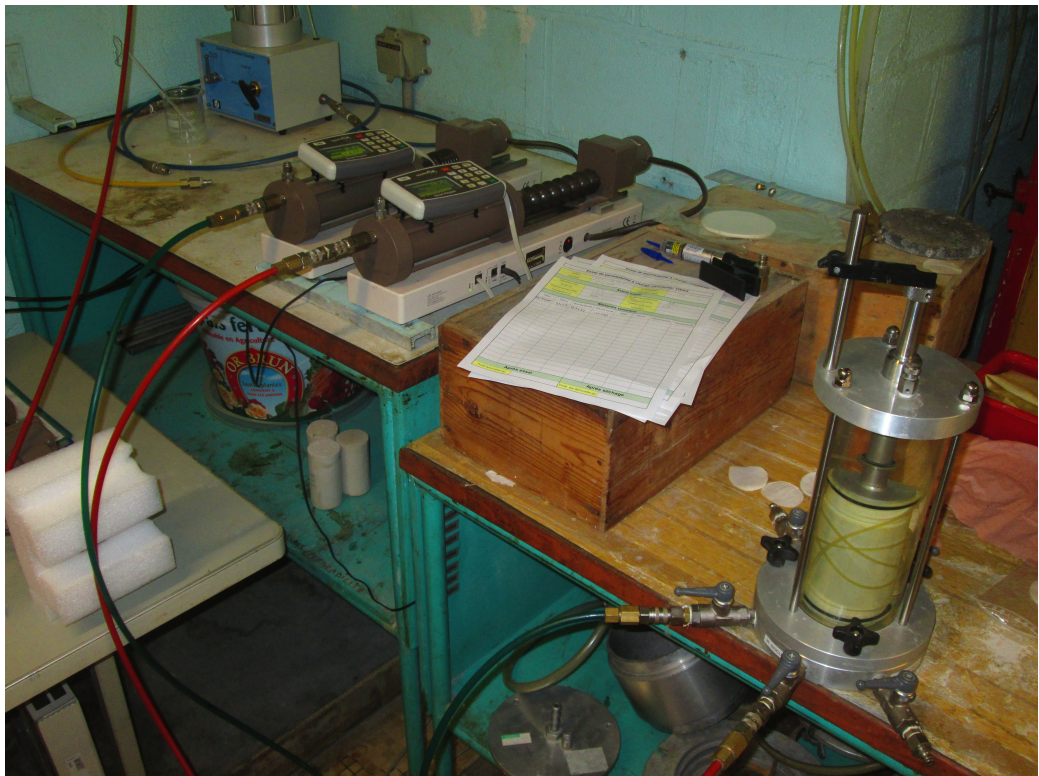
Figure 111 : Vue du montage des éprouvettes en phase de saturation avant réalisation des mesures de perméabilité.
