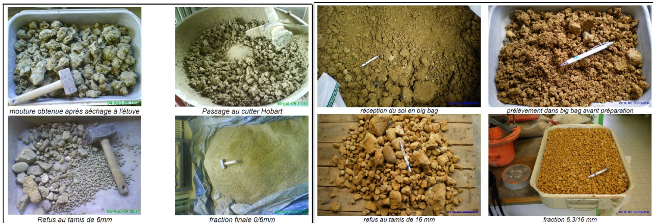
Figure 71 : Préparation de l'argile A3/A4 et du limon A2 du projet TerDOUEST (Froumentin, 2012)
