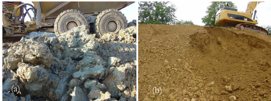
Figure 70 : Exemple de sols foisonnés mis en stocks (crédit photo TerDOUEST) (a) argile A3/A4 (b) limon A2.
