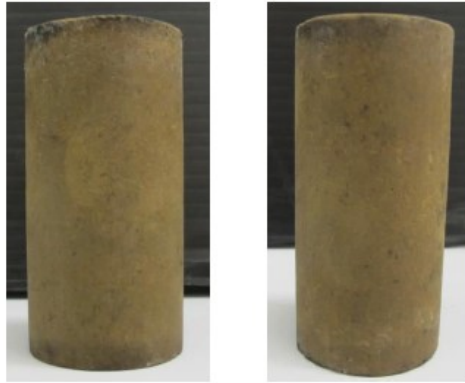
Figure 98 : Exemple de deux éprouvettes du limon non traité ayant subi 12 cycles hydriques par la méthode Hr alternant humidification par remontée capillaire et séchage doux (Mehenni, 2015).
