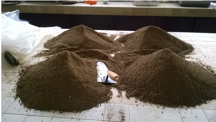
Figure 59 : Etape finale du quartage des limons sableux de La Ville-aux-Dames avant mise en sac, et après homogénéisation en un seul échantillon initial.
