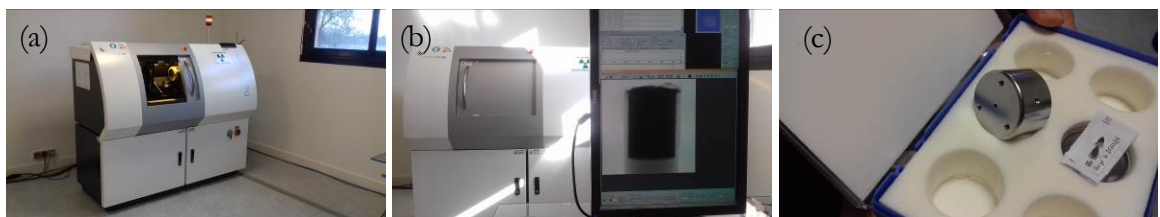
Figure 121 : tomographe à rayons X de l'Isto, (a) vue d'ensemble porte ouverte, (b) vue depuis l'ordinateur de contrôle porte fermée, (c) source de rayons X de rechange (le faisceau est émis depuis le trou central)
