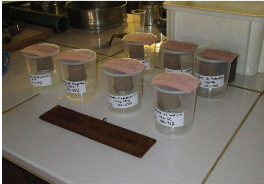
Figure 103 : Conservation des 7 éprouvettes 5×5 cm compactées statiquement à w = 12,2\% ( w_{OPN}+1,3\% ) et \rho_d = 1,827 \text{ t/m}^3 (94% de \rho_{d OPN} ), en étui étanche pour mise en équilibre hydrique avec des solutions salines saturées.
