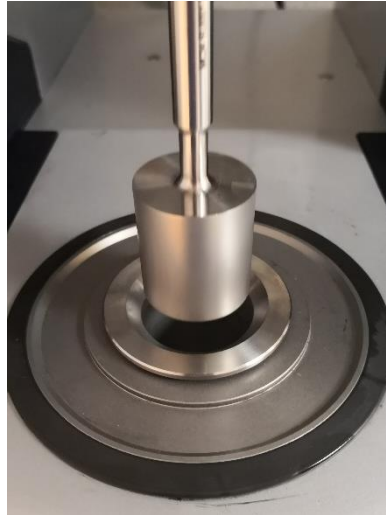
Figure 2-8 : Géométrie Couette pour déterminer la viscosité des huiles.
