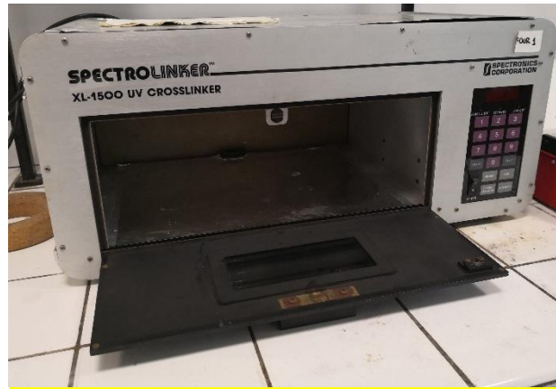
Figure 3-1 : Four Spectrolinker XL-1500 UV, équipé de 6 lampes de 15 W émettant à \lambda = 365\text{nm} .
